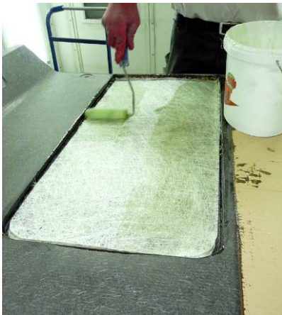
Abbildung 126: Laminieren und stabilisieren der Aussparungen für Abgasführung „Bodenplatte I“
