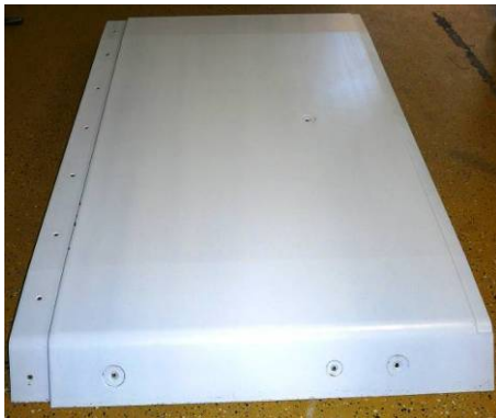
Abbildung 129: „Bodenplatte II“ gefräst, Ansicht Außen und Innen
