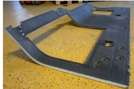
Abbildung 135: „Seitenklappe IV“ gefräst, Ansicht Außen und Innen
