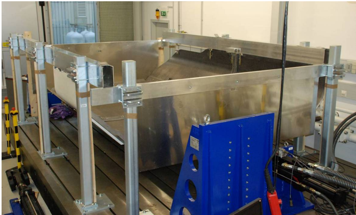
Abbildung 141: Aufbau des Demonstrators auf dem Spannfeld
