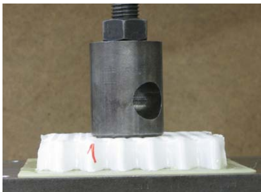
Abbildung 95: Stempel zum lokalen Verpressen von Faltkernen
