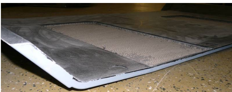
Abbildung 125: Gefräste Aussparung für Abgasführung „Bodenplatte I“
