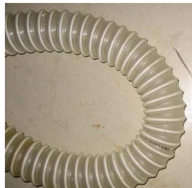
Abbildung 24: Knicken des Spiralschlauchs
