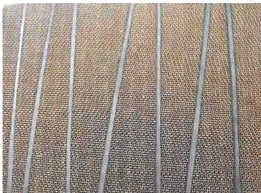
Abbildung 60: Imprägnierte Endlosfaserstränge nach dem Verpressen [Kup-12]
