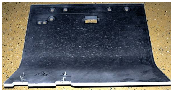
Abbildung 134: „Seitenklappe III“ gefräst, Ansicht Innen und Außen
