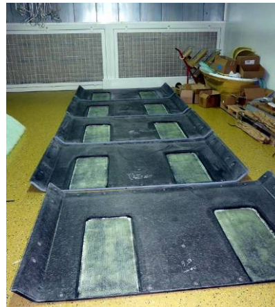
Abbildung 126: Laminieren und stabilisieren der Aussparungen für Abgasführung „Bodenplatte I“
