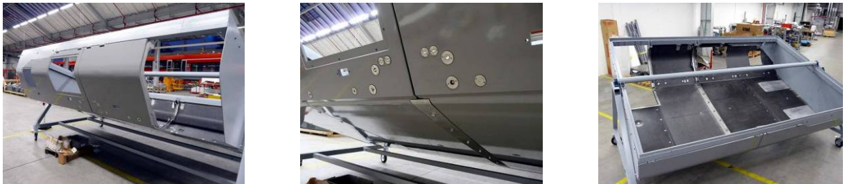
Abbildung 138: Zusammenbau sämtlicher Einzelbauteile zur Gesamtkonstruktion Motoreinhausung
