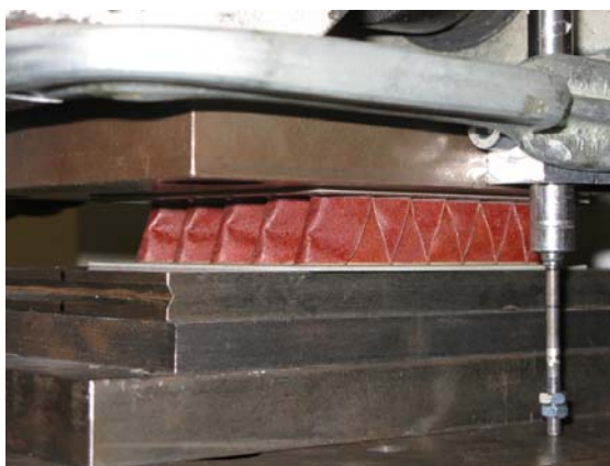
Abbildung 94: Prüfaufbau für den Druckversuch (li) und den transversalen Schubversuch (re)
