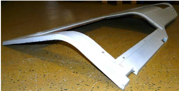
Abbildung 135: „Seitenklappe IV“ gefräst, Ansicht Außen und Innen
