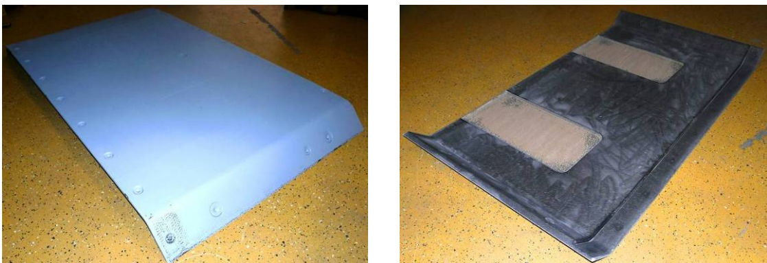
Abbildung 128: „Bodenplatte I“ gefräst, Ansicht Außen und Innen
