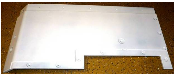
Abbildung 131: „Bodenplatte IV“ gefräst, Ansicht Außen und Innen
