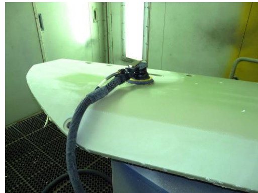
Abbildung 136: Auftrag von Spritzspachtel „Bodenplatte I“ (links) und Schleifen des Spritzspachtel „Seitenklappe II“(rechts)
