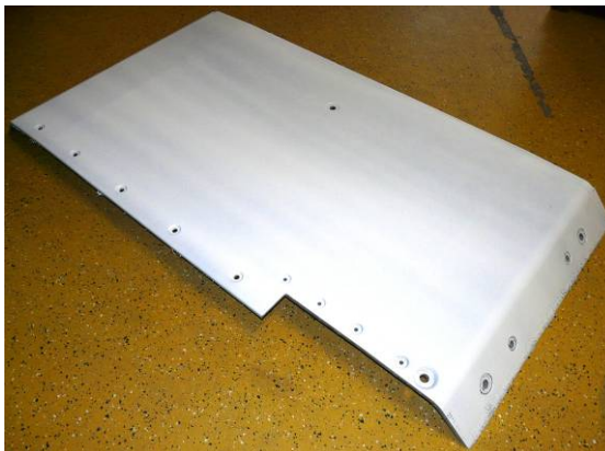
Abbildung 130: „Bodenplatte III“ gefräst, Ansicht Außen und Innen
