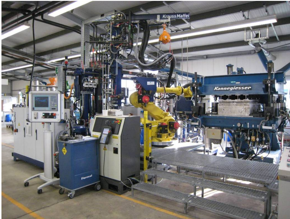
Abbildung 65: Vier-Komponenten-PUR-Fasersprühanlage im Technikum des Fraunhofer ICT
