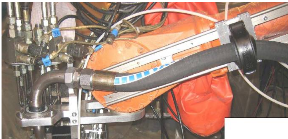
Abbildung 29: Linear-Schlitten-System an der vierten Roboterachse
