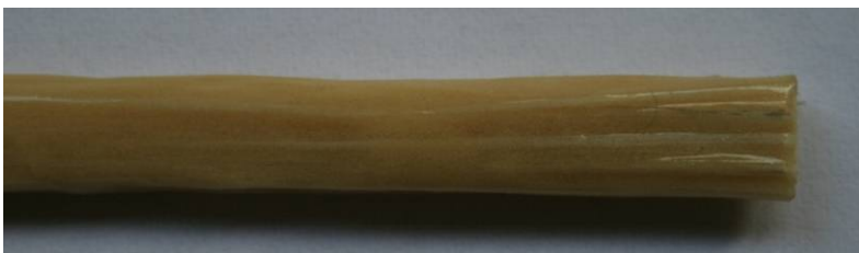
Abbildung 57: Imprägnierter 2400er TEX-Glasfaser (Vetrotex T207)
