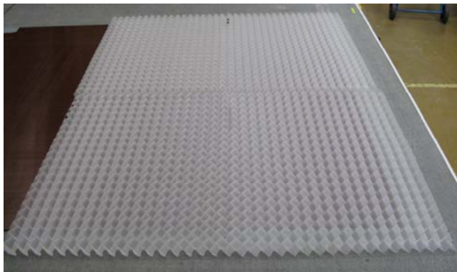
Abbildung 98: Faltkernpaneele aus Polycarbonat für Anbindungsversuche am Fraunhofer ICT
