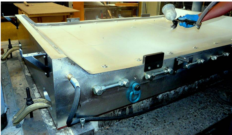
Abbildung 127: Eintrag von Trennmittel und IMC ins Werkzeug „Bodenplatte I“
