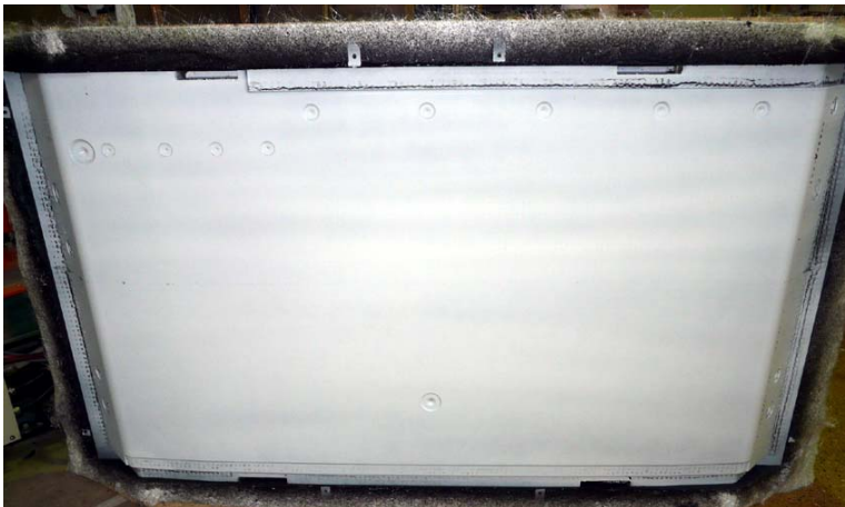
Abbildung 102: Fertiges Demonstratorbauteil mit Faltkernen als Kernmaterial
