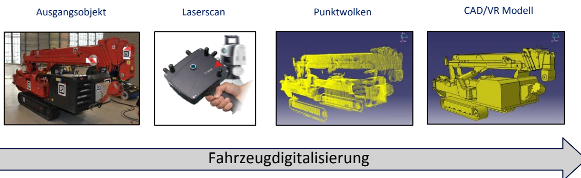
Abbildung 5: Prozess Fahrzeugdigitalisierung CAD/VR-Modell
