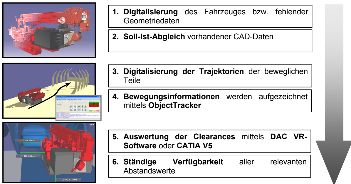
Abbildung 8: Digitalisierungsprozess einer Fahrzeugeinfahrt
