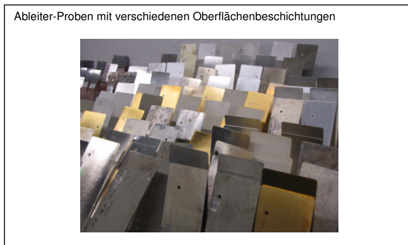
Abbildung 20: Ableiterproben mit verschiedenen Oberflächenbeschichtungen
