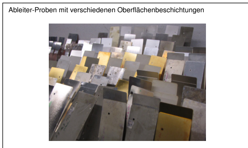
Abbildung 20: Ableiterproben mit verschiedenen Oberflächenbeschichtungen
