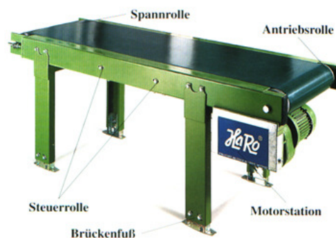
Abbildung 25: Alternatives Transportsystem für Schwerlasten zu Hubtischwagen
