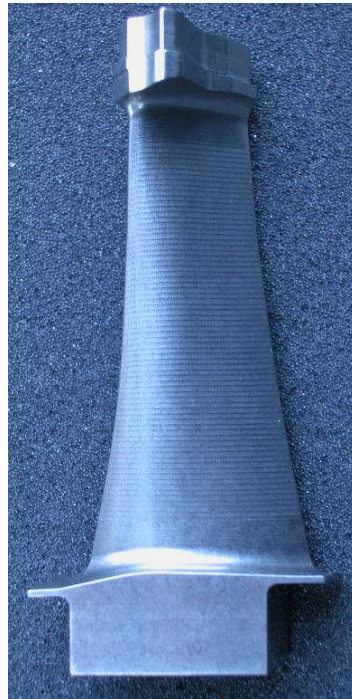
Abbildung 60: Axf Testkörper einer NDT Schaufel aus TiAl (geschmiedet und gefräst)
