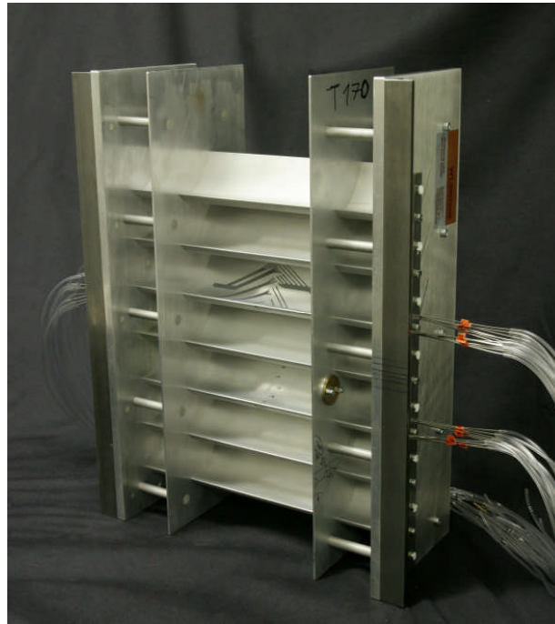
Abbildung 38: Gitterträger für das Low-Re-Gitter T170
