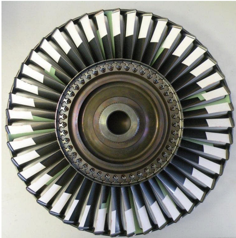
Abbildung 63: Triebwerksrotor (NDT) mit TiAl Beschichtung vor dem Test
