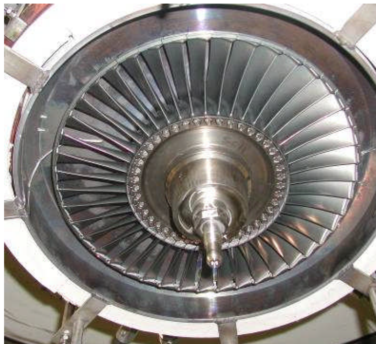
Abbildung 62: Triebwerksrotor (NDT Stufe 2) für den Nachweis ausreichender LCF Lebensdauer und Untersuchung des Verschleißverhaltens der TiAl NDT Schaufel an der Kontaktstelle der Schaufel/Scheibeverbindung und im oberen Deckband
