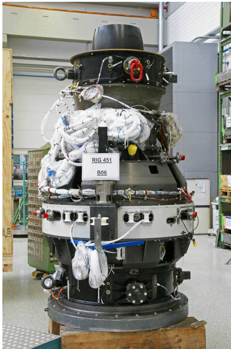
Abbildung 34: Rig 451 versandbereit für den Versuch am Höhenprüfstand des Instituts für Luftfahrtantriebe (ILA) der Universität Stuttgart
