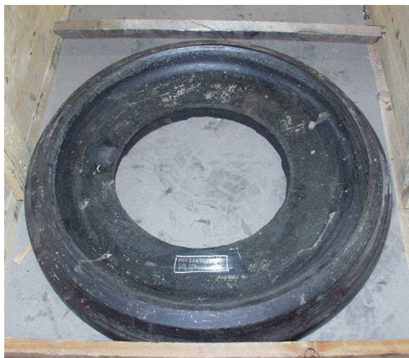
Abbildung 10: Schmiederohteil DA718 im Anlieferungszustand
