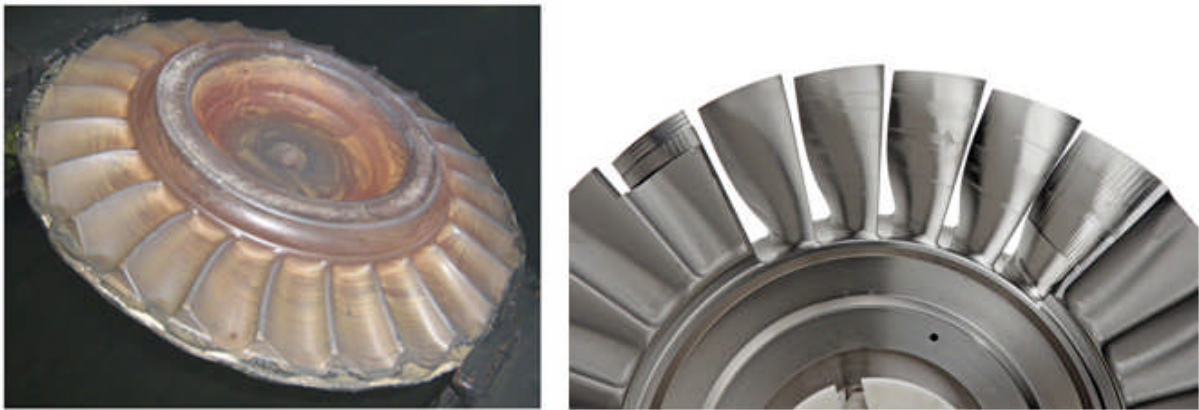
Abbildung 8: Erste Endbearbeitungsversuche demonstrieren die Machbarkeit
