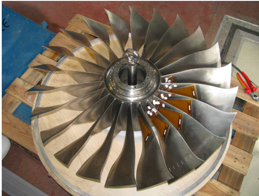
Abbildung 32: Transsonischer Verdichter-Rotor in Blisk-Bauweise
