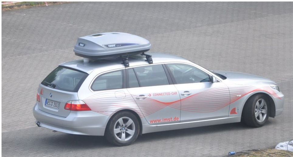
Abbildung 4.1: Versuchsfahrzeug der IMST GmbH mit Antennensystem in der Dachbox.
