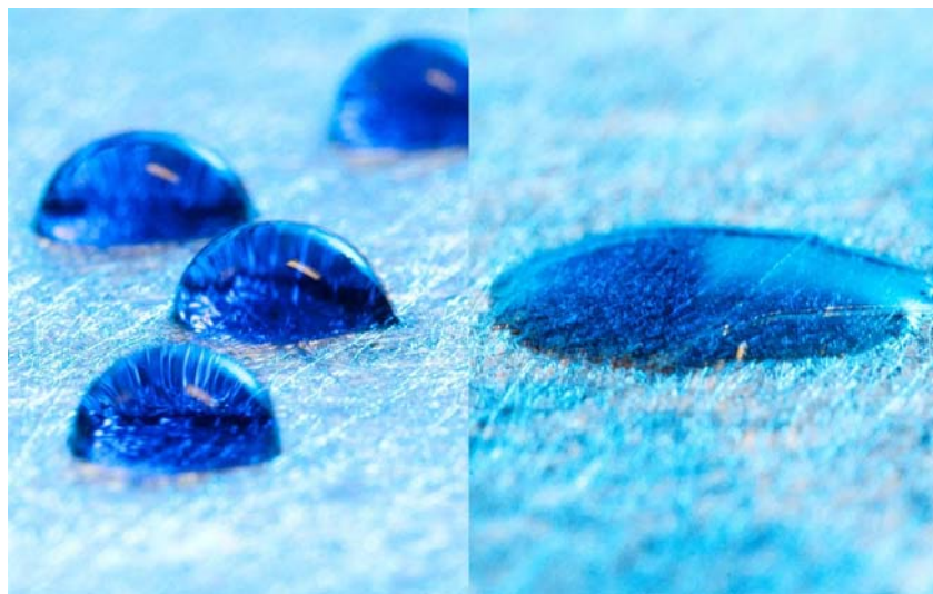
Abbildung 83: Vergrößerter Ausschnitt der definiert hydrophob und hydrophil ausgerüsteten Vliesstoffe.
