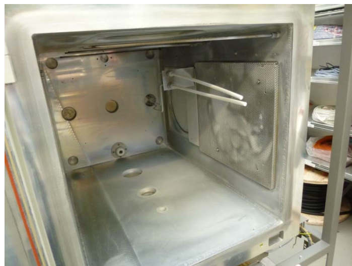
Abbildung 77: Kammer mit Kunststoff-Gaslanzen nach den ersten Beschichtungsprozessen.
