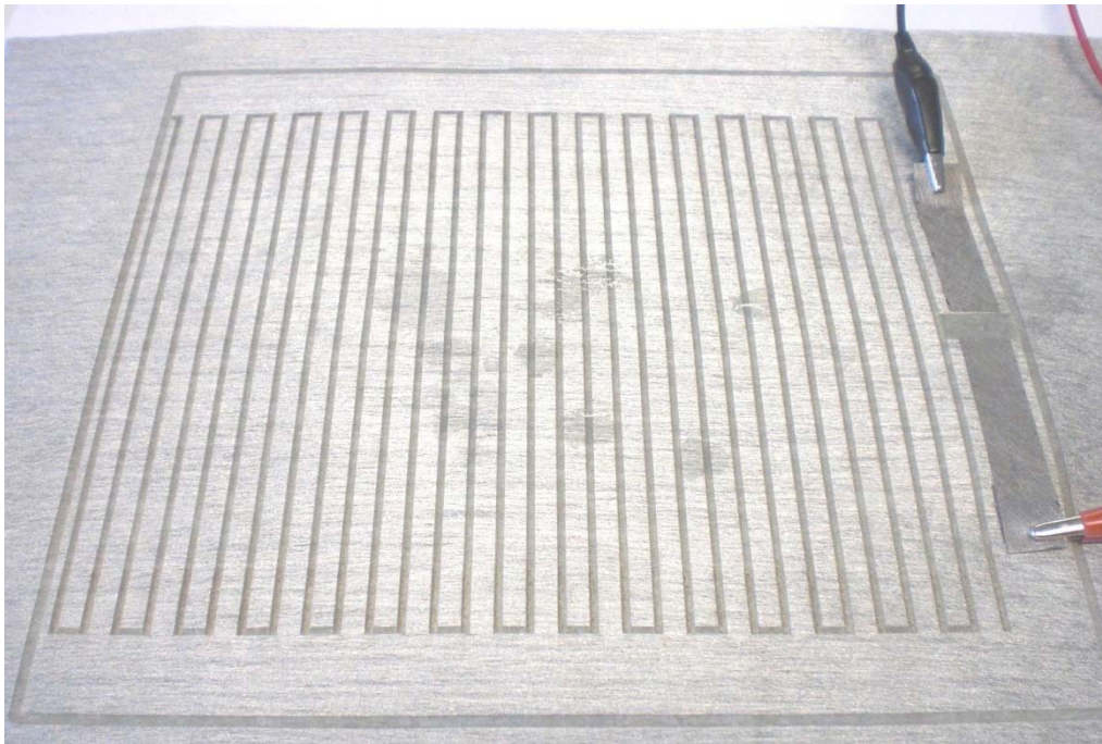
Abbildung 85: Realisierung einer Basiseinheit für die Herstellung eines Feuchtesensors.
