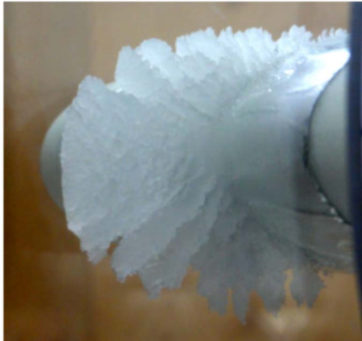
Abbildung 70: Raueis - Seitenansicht; nach 8 min.
