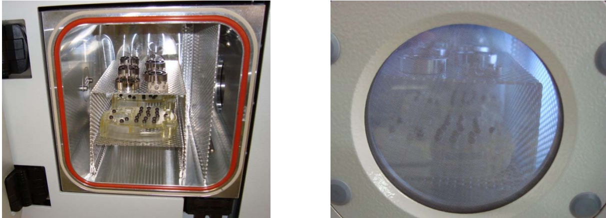
Abbildung 10: Kugellagerbeschichtung in einer Plasmaanlage vom Typ V6-G, links vor dem und rechts während des Prozesses.
