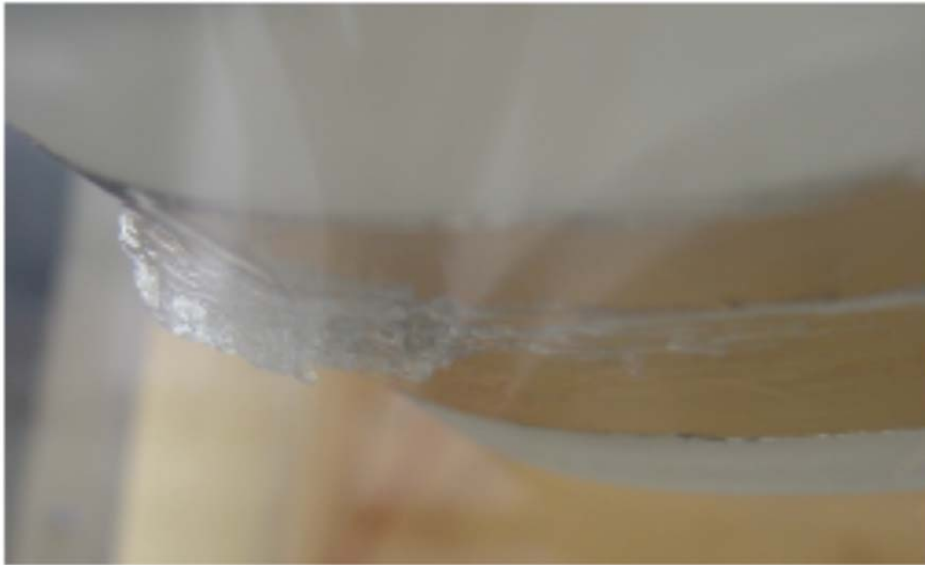
Abbildung 68: Entstehung von Runback ice.
