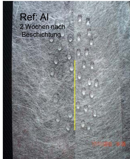
Abbildung 82: Metallisierte Vliesstoffoberflächen (Al) mit hydrophiler (links unten). Und hydrophober Ausrüstung (rechtes Bild, rechts). Ohne eine Ausrüstung verändern die Benetzungseigenschaften von ursprünglich hydrophil nach hydrophob.
