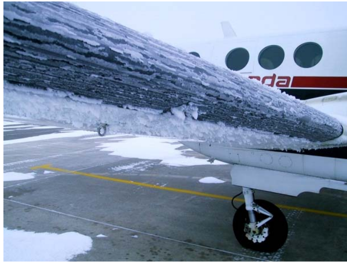
Abbildung 41: Foto eines vereisten Tragflügels einer King Air nach dem Flug [12].
