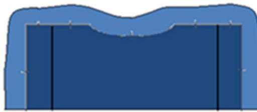
Abbildung 8: Schematische Darstellung des beschichteten Innenrings mit Schichtdarstellung. Dunkelblau: Innenring; hellblau: Beschichtung (überhöht dargestellt).
