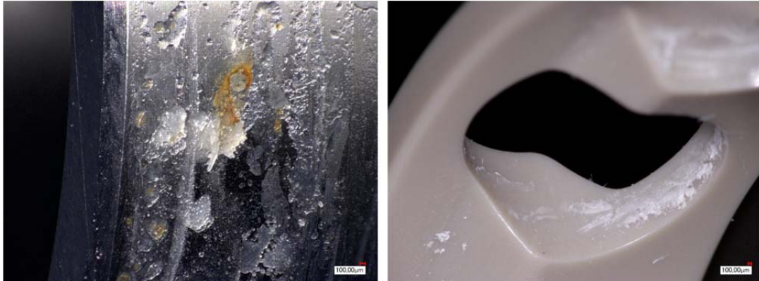
Abbildung 35: Innenring, Käfig nach Reinigungsprozess, Referenz.
