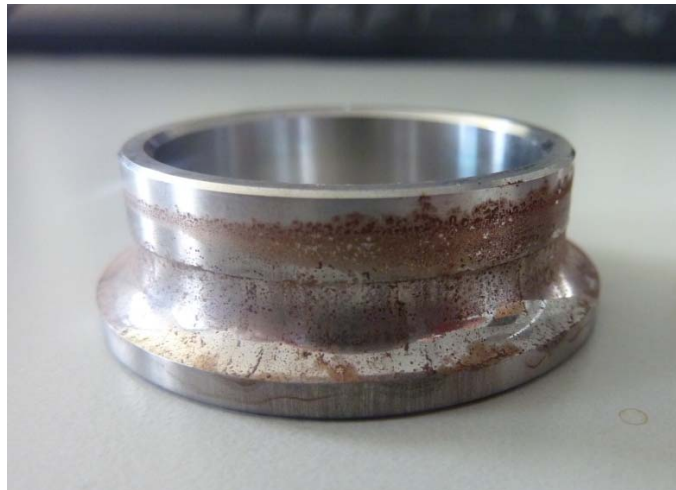
Abbildung 34: Innenring Schrägkugellager 7006 nach Milchschröpfung.
