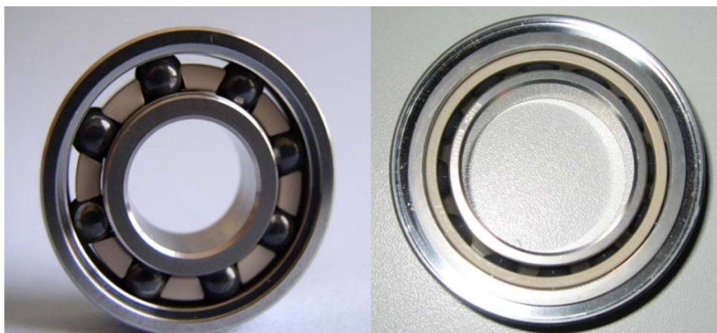
Abbildung 27: Rillenkugellager 6001 und Schräggugellager 7006 für Modell- und Bauteilversuche.
