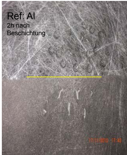
Abbildung 82: Metallisierte Vliesstoffoberflächen (Al) mit hydrophiler (links unten). Und hydrophober Ausrüstung (rechtes Bild, rechts). Ohne eine Ausrüstung verändern die Benetzungseigenschaften von ursprünglich hydrophil nach hydrophob.
