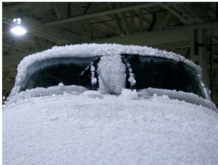
Abbildung 42: Eisbildung auf der Flugzeugvorderseite einer King Air [12].
