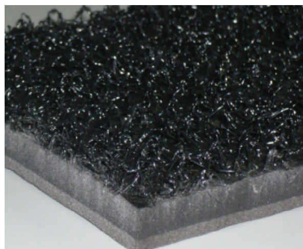
Abb. 2.45: Schwellensohlen werden bei der Herstellung mit einem Kunststoffgeflecht („Wirrgelege“) versehen. Die so hergestellten Schwellensohlen werden bei der Herstellung von Betonschwellen an die noch nicht gehärteten Betonschwellen angefügt und somit verbunden.
