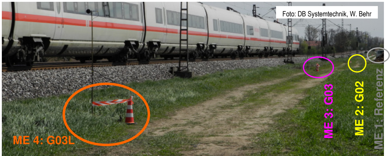
Abb. 3.34: Zugfahrt eines ICE auf dem Testgleis mit unterschiedlichen besohlenen Schwellen. Eine Bestimmung der Einfügedämmung durch Vergleich der Erschütterungen in einem bestimmten besohlenen Abschnitt mit dem unbesohlenen Referenzabschnitt ist nur bei vergleichbaren Bodeneigenschaften in beiden Abschnitten möglich.
