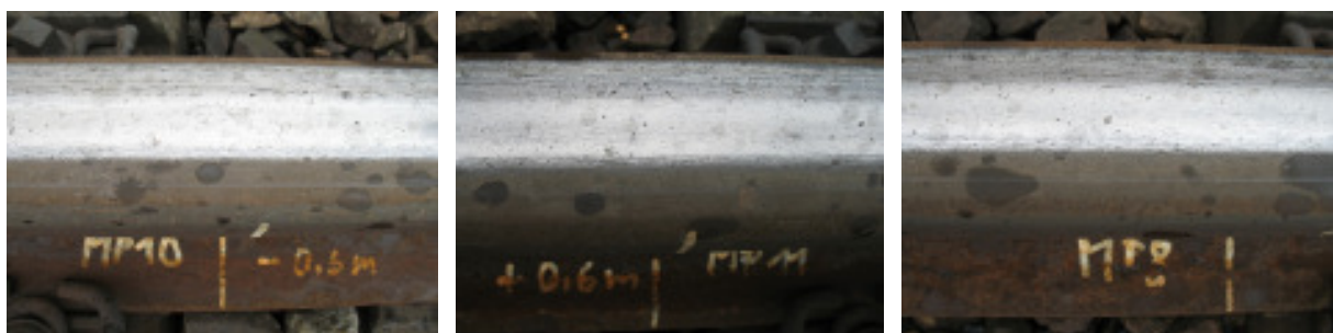
Abb. 2.24b: repräsentative Stichproben der Schienenfahrfläche im ungedämpften Referenzabschnitt
