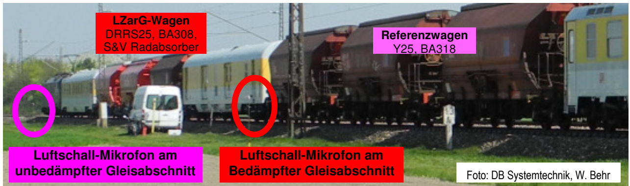
Abb. 3.26a: Die Bestimmung der Gesamtwirkung aller Maßnahmen erfolgte für jede Wagengruppe separat durch Vergleich der Schallabstrahlung der LZarG-Wagengruppe auf dem realen bedämpften mit der Schallabstrahlung der Referenz-Wagengruppe auf dem realen bedämpften Gleisabschnitt.
