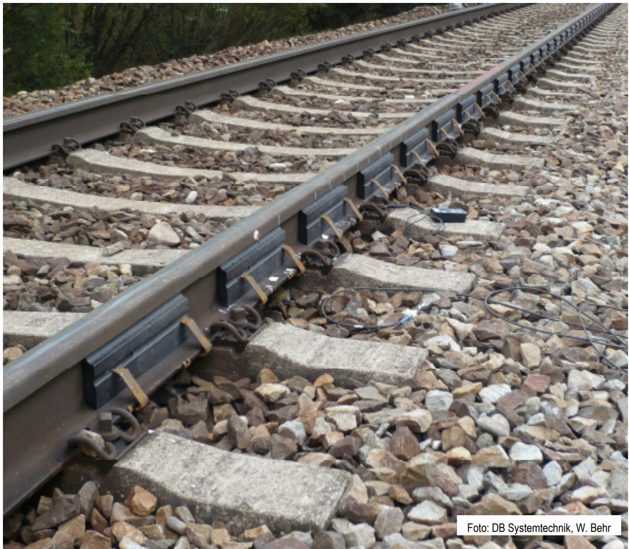
Abb. 2.12c: Prototyp „Schienendämpfer kurz ohne Koppelschicht, Montage jeweils im Schwellenfach“
