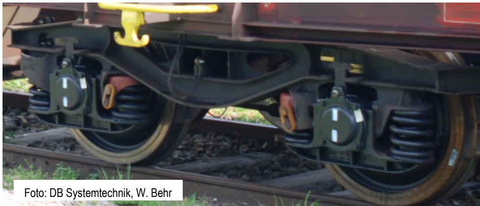
Abb. 3.17: Die Referenz-Wagengruppe hatte Y25-Drehgestelle mit Radsätzen der Bauart 318.
