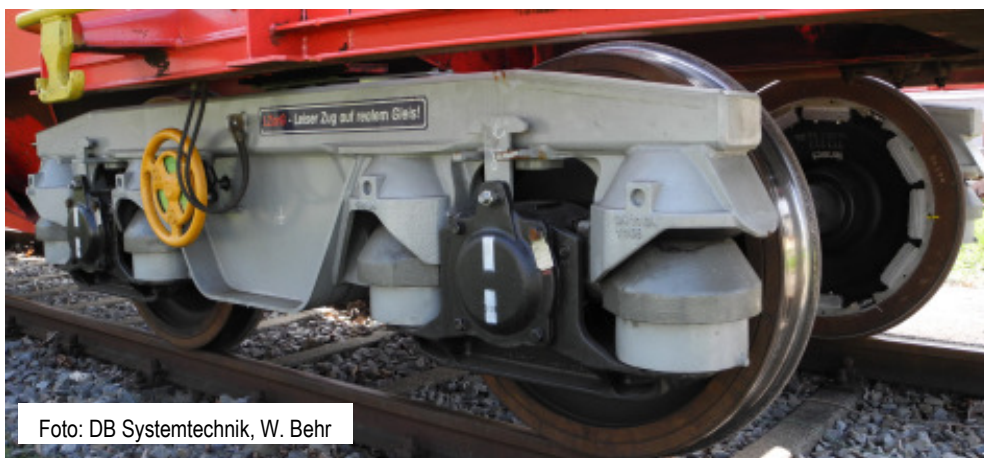
Abb. 3.18: Drehgestell DRRS25L der Fa. Waggonbau Niesky GmbH mit der kompakten Klotzbremse CFCB der Fa. Knorr, Gummifederung der Fa. Contitech und gedämpften GHH-Radsätzen der Bauart 308 mit S&V-Radabsorbern
