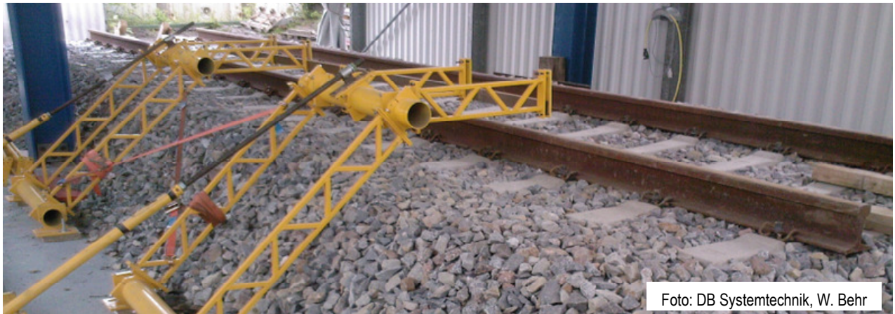
Abb. 2.15: Der Prüfstand der TU München: ein kompletter Schotteroberbau (Länge: 12 m)
