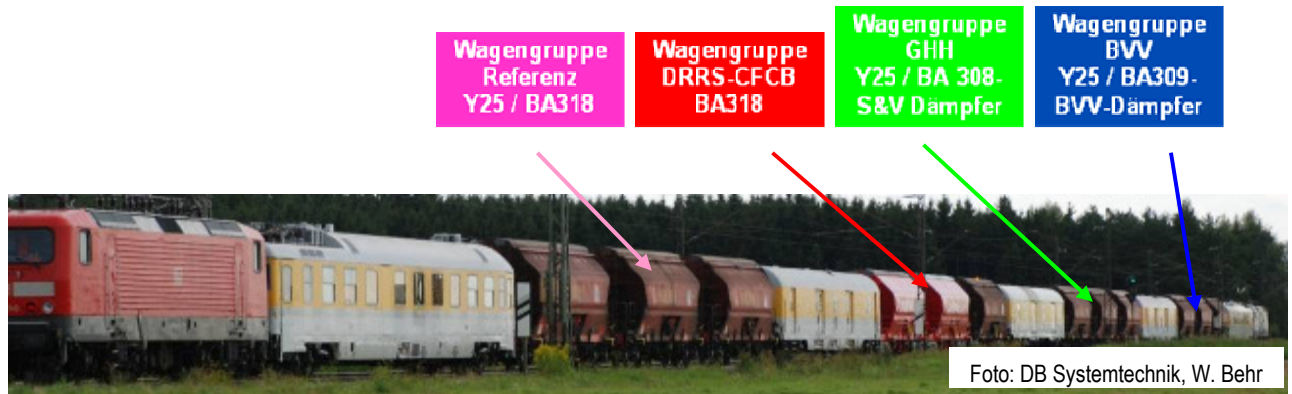
Abb. 3.7: Die akustischen Effekte der entwickelten Einzelmaßnahmen wurden mit einem speziell zusammengestellten Testzug ermittelt.
