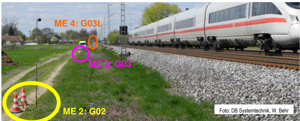
Abb. 3.35: Zugfahrt eines ICE auf dem unbesohlenen Gegengleis. Die durch diese Zugfahrt verursachten und mit den Körperschallsonden in den jeweiligen Messabschnitten gemessenen Erschütterungen ermöglichen eine Bewertung der Bodenbeschaffenheit der einzelnen Messebenen.
