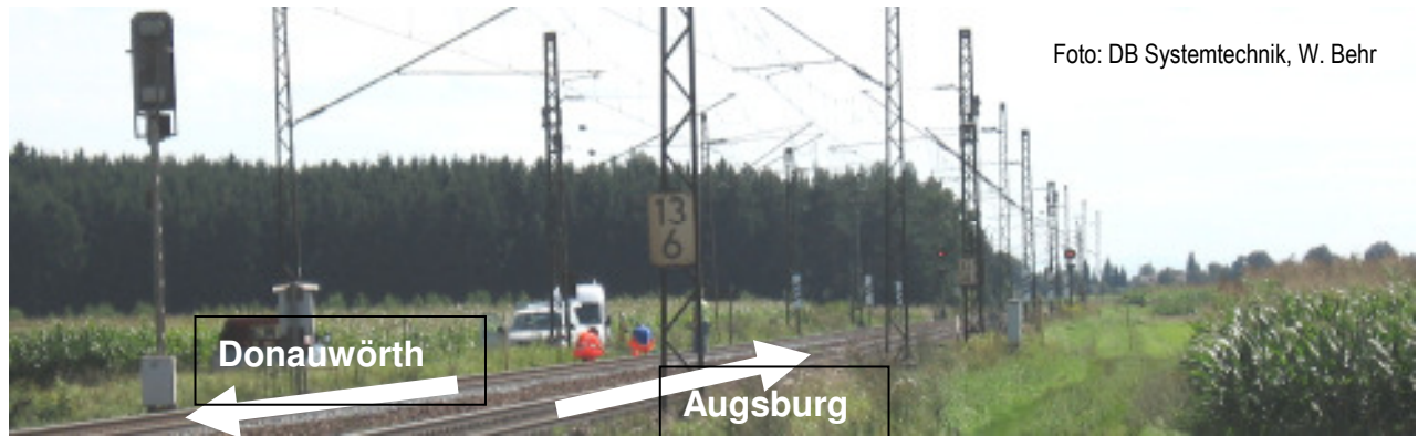
Abb. 3.11a: Die Messungen wurden auf der Strecke Augsburg-Donauwörth in der Nähe von Langweid durchgeführt. Dort war die Strecke gerade ohne eine Dammlage, die Schallausbreitungsbedingungen waren ideal und es gab keine Störgeräusche in der Umgebung.
