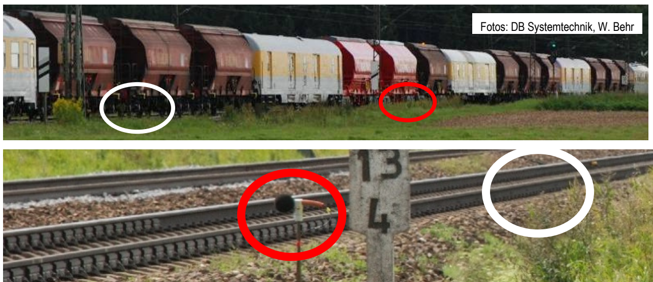
Abb. 3.16a: Die Bestimmung der Gesamtwirkung aller Maßnahmen erfolgte für jede Wagengruppe separat durch Vergleich der Schallabstrahlung der jeweiligen Wagengruppe auf dem realen bedämpften mit der Schallabstrahlung der Referenz-Wagengruppe auf dem realen bedämpften Gleisabschnitt.
