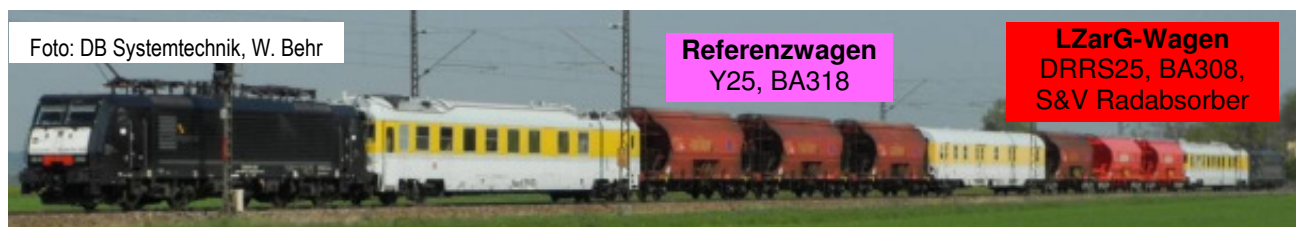
Abb. 3.19: Der akustische Gesamteffekt aller entwickelten Maßnahmen wurde mit einem speziell zusammengestellten Testzug ermittelt.
