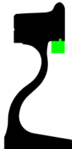
Abb. 3.5: Radsatz BA 308 der Fa. GHH mit Raddämpfern vom Typ VICON-RSI der Fa. Schrey & Veit GmbH
