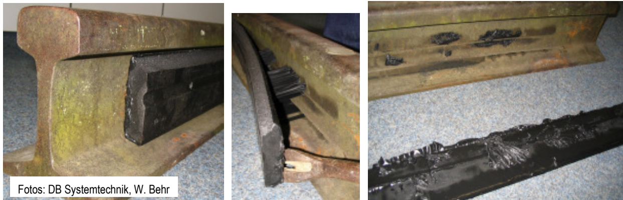
Abb. 2.7: Eine anfangs entwickelte Ankoppelschicht ermöglichte eine gute akustische Ankoppelung an die Schiene und erlaubte zugleich ein rückstandslose Entfernung des Dämpfers von der Schiene.
