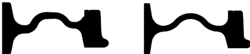
Abb. 3.43: Anstelle des Standardrades BA004 (rechts) wurde das Rad BA318 (links) als Referenzrad im LZarG-Testzug verwendet. Die Radscheibe des BA318 ist etwas dicker und anders geformt, so dass diese Radbauform BA318 bereits etwas leiser ist als die Radbauform BA004.
