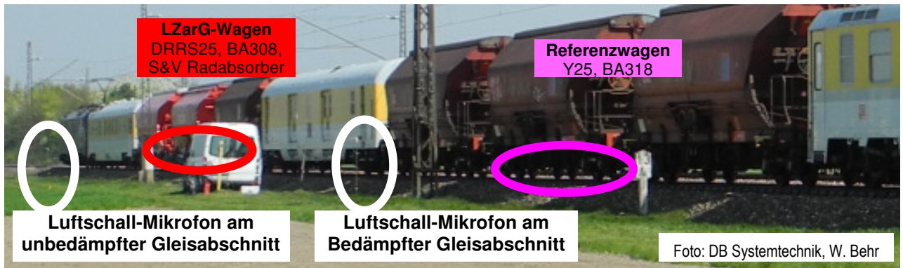
Abb. 3.25a: Die Wirkung der Schienendämpfer wurde für jede Wagengruppe separat bestimmt durch Vergleich der Schallabstrahlung auf dem realen unbedämpften und dem realen bedämpften Gleisabschnitt.
