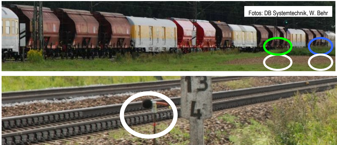
Abb. 3.14a: Die Bestimmung der Wirkung der Radabsorber erfolgte für jeden Messabschnitt (Foto exemplarisch: bedämpfter Gleisabschnitt) separat durch Vergleich der Zugvorbeifahrt der Wagen mit Radabsorber (Messwoche 1) und der vergleichbaren Zugvorbeifahrt der Wagen ohne Radabsorber (Messwoche 2).
