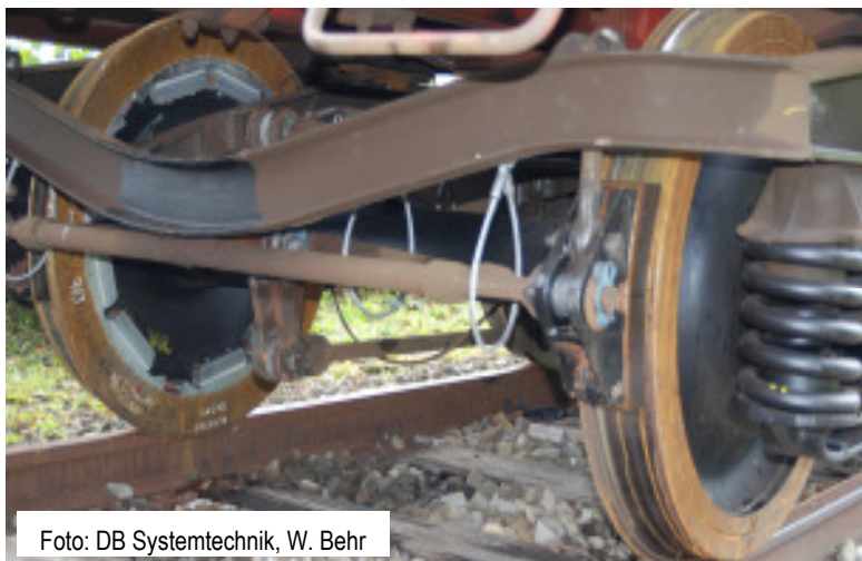
Abb. 3.5: Radsatz BA 308 der Fa. GHH mit Raddämpfern vom Typ VICON-RSI der Fa. Schrey & Veit GmbH
