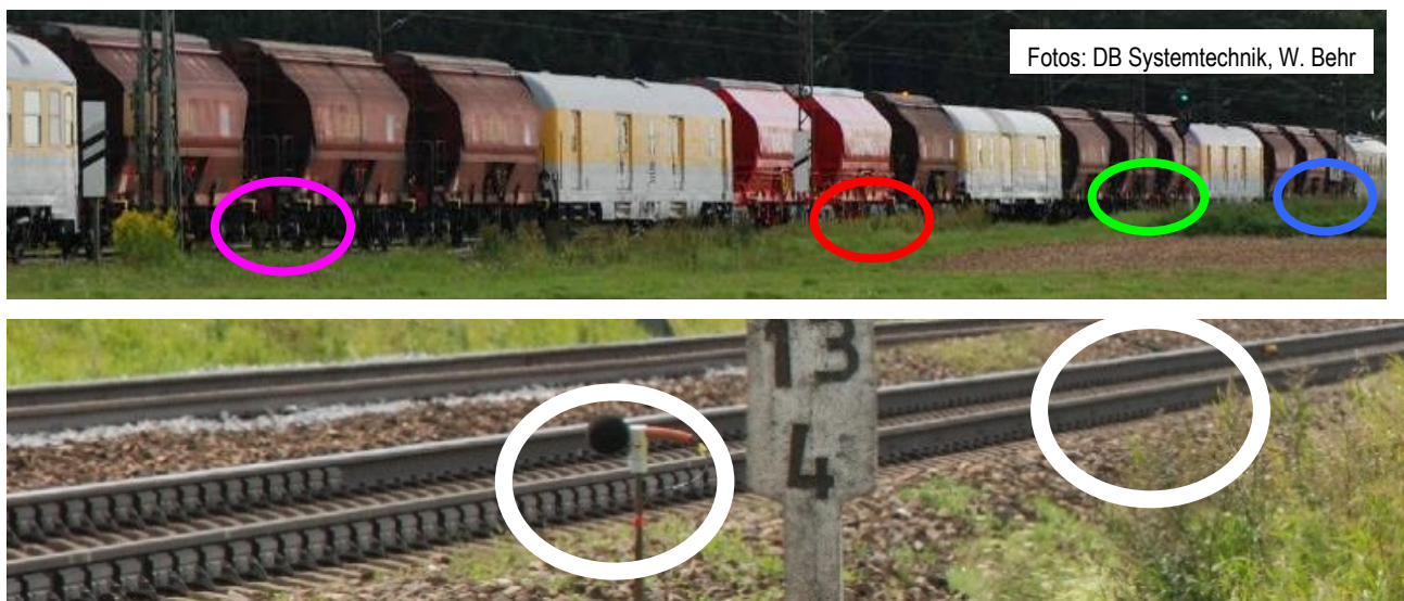
Abb. 3.15a: Die Wirkung der Schienendämpfer wurde für jede Wagengruppe separat bestimmt durch Vergleich der Schallabstrahlung auf dem realen unbedämpften und dem realen bedämpften Gleisabschnitt.
