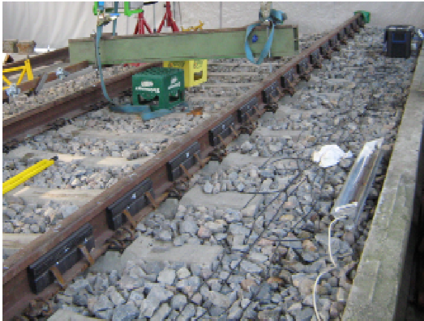
Abb. 2.20: Messung der Gleisabklingrate des Testgleises der TU München mit bzw. ohne Schienendämpfern der Fa. Vossloh.
