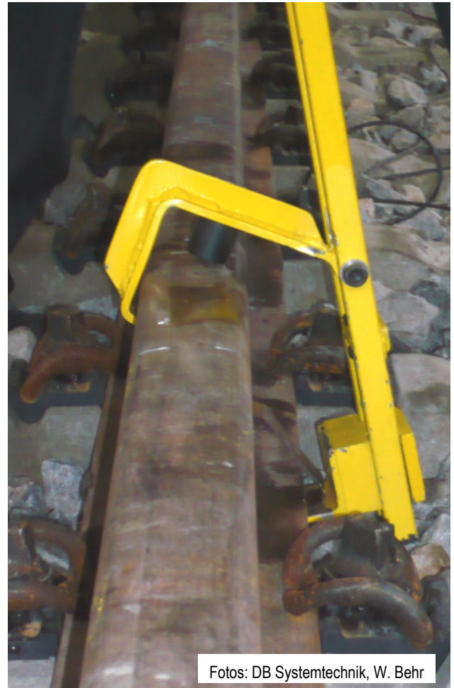
Abb. 2.14b: Das weiterentwickelte Einbauwerkzeug zur Montage der Dämpfer zeigte deutliche Vorteile bzgl. des ersten Prototypen des Einbauwerkzeugs.
