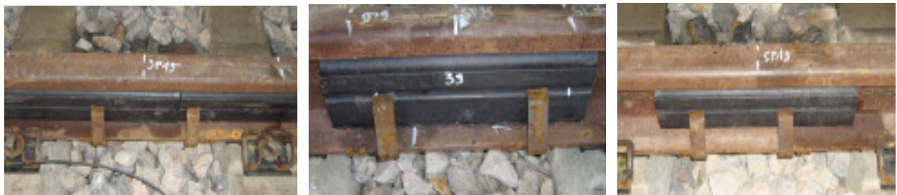
Abb. 2.21: Am Gleisprüfstand der TU München wurde die Gleisabklingrate des gedämpften Gleises mit allen drei Prototypen gemessen.
