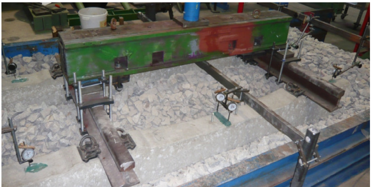
Abb. 2.59: Laborversuche in der TU München an einer besohnten Schwelle (linkes) bzw. an einem Teilstück einer Schwellenbesohlung (rechts).
