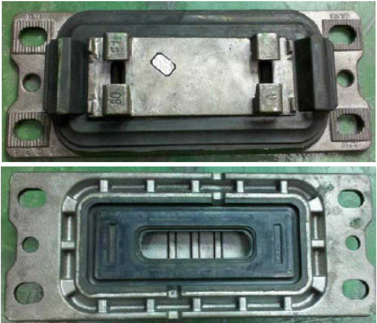
Abb. 2.58: Prototyp der hochelastischen Schienenbefestigung LIZARG der Fa. Vossloh Fastening Systems: Draufsicht (oberes Foto) und Untersicht (unteres Foto).
