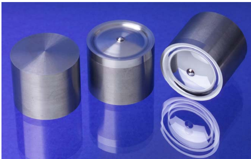
Abbildung 2-20: Demonstrator 2, Rohteil, gedreht, poliert
