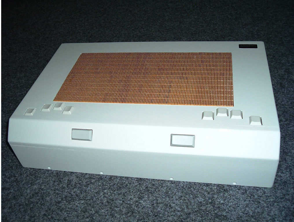
Abbildung 1 Stiftplatte 1 aus überarbeiteten BrailleDis-Modulen
