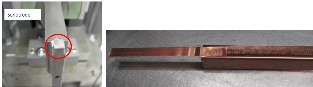
Abbildung 148: Schweißversuche mit Zellelektrode und Sense-Leitung
