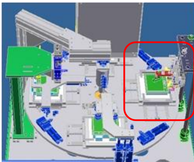
Abbildung 181: Zellelektroden kontaktieren, Überprüfung el. Größen
