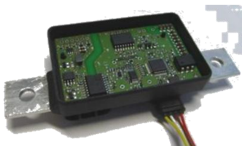
Abbildung 46: Stromsensor FUEL Demonstratoren (ohne Deckel)
