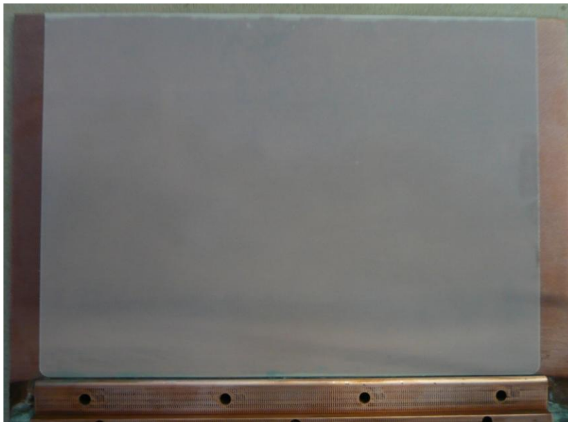
Abbildung 164: Optimal beklebtes Kühlblech, frei von Luftblasen
