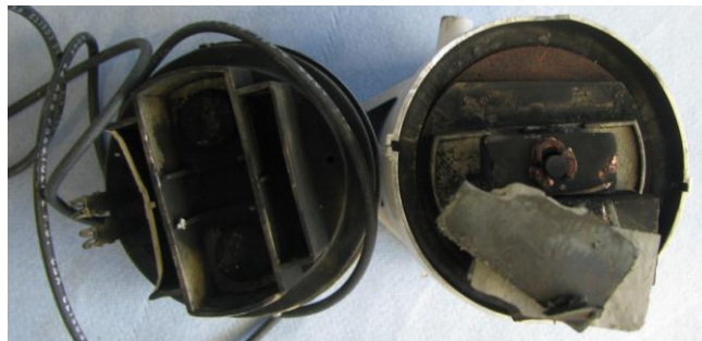
Abbildung 191: Explodiertes Schütz nach mehrmaligem Schalten unter Last (450V/2000A)
