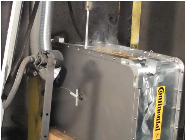
Abbildung 232: Eindringen eines Nagels in den Energiespeicher (BF1-60)
