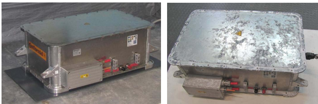
Abbildung 225: Salzsprühnebeltest BF1-60: Energiespeicher vor und nach dem Test
