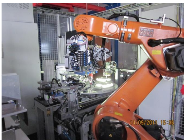
Abbildung 184: Automatisierung der Prüfung der Zellen
