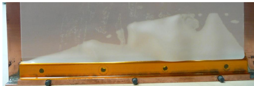
Abbildung 160: Fehlerbild – abgelöstes Klebepad bei Entfernung des Liners
