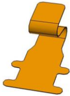
Abbildung 145: Cu-Fähnchen mit S-Schlag zur Positionierung der Sense-Leitung
