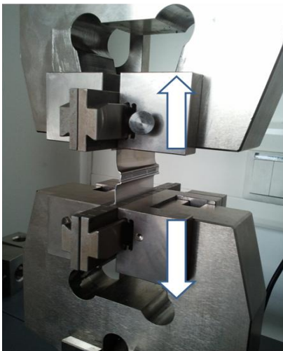
Abbildung 117: Zugversuch (statische Versuchsplanung, DOE)
