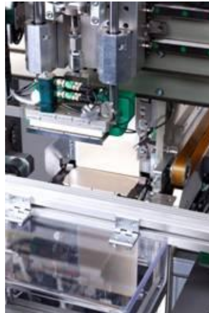
Abbildung 168: Portal zum Kühlblech- handling / Pressen
