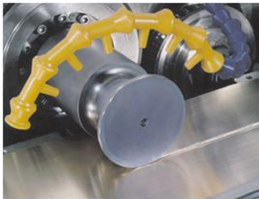
Abbildung 19: Nahaufnahme einer kontinuierlichen Ultraschall-Schweißung bei gleichen Materialien
