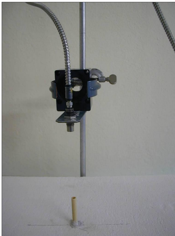
Bild 16: Positionierung der Pyrometeroptik über einem in das Ofendach eingeklebten Keramikröhrchen mit der Länge von 100 mm und dem Innendurchmesser von 5 mm
