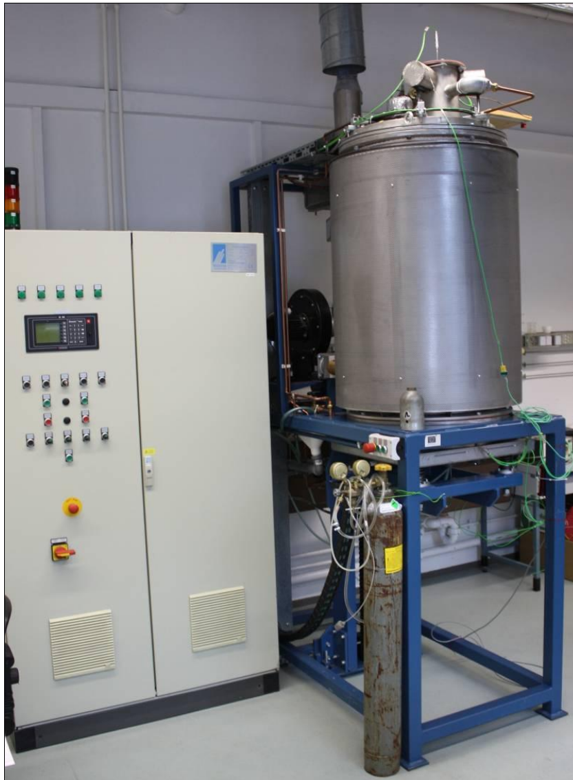
Bild 17: Aggregat zur Sinterung großformatiger keramischer Folien an der BAM
