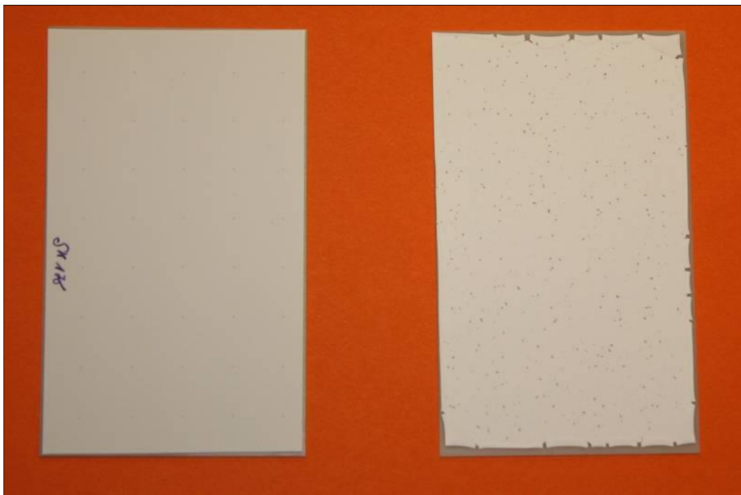
Bild 35: Aluminiumnitridplatte (6 cm x 10 cm) mit auflaminiertem Tape vor und nach der Sinterung
