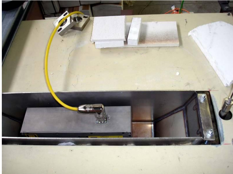
Bild 49: Einbau des Laserlichtschnittsensors in das Ofendach
