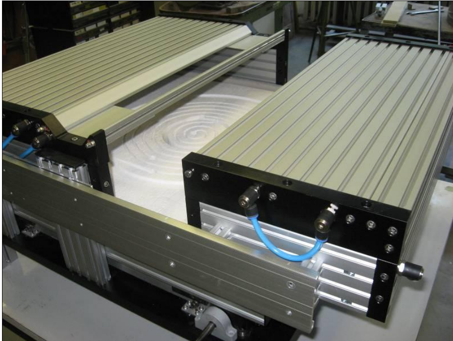
Bild 19: Rohbau des Spezialofens (geöffnet; links - fest angeordnetes Oberteil mit vorbereitetem Schlitz, rechts - für den Probenwechsel verschiebbares Oberteil, Mitte - spiralförmiger Spalt für den Heizdraht in der Isolation des Unterteils)
