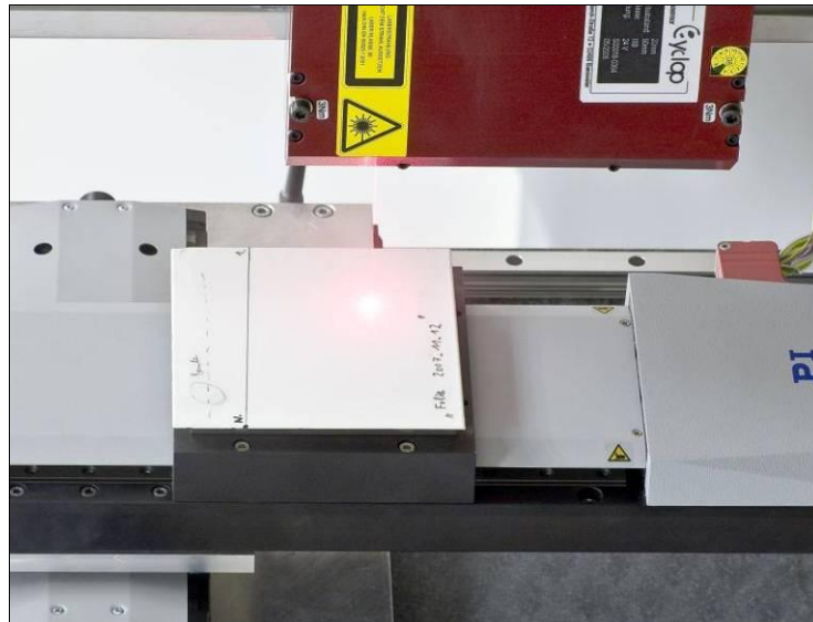
Bild 2: Anordnung zur Laserabstundmessung mit einem Präzisionsmesstisch: oben Lasertriangulationssensor, unten x - y -Positioniereinrichtung mit Folie
