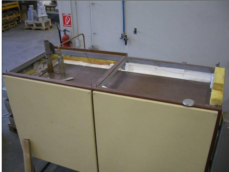
Bild 47: Entbinderungs-ofen der Fa. Tridelta im ursprünglichen Zustand
