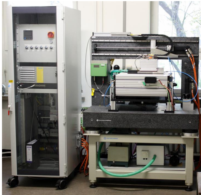
Bild 21: Testgerät zur Hochtemperatur-Laserprofilometrie: Gesamtansicht
