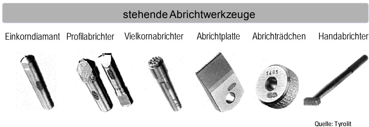
Bild 4: Üblicher Abrichtprozess für Schleifwerkzeuge
