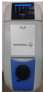
Abbildung 133: Fertiges System in der endgültigen Ausführung, sowohl als Master als auch als Satellit einsetzbar.
