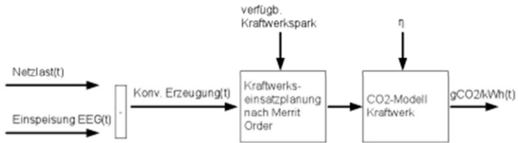
Abbildung 20: Modell zur Ermittlung des CO 2 -Emissionsfaktors
