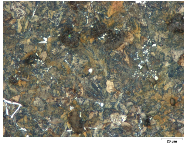
ca. 500x, Kernbereich Schliff Perlit, ca. <1% Ferrit und <1% Karbide
