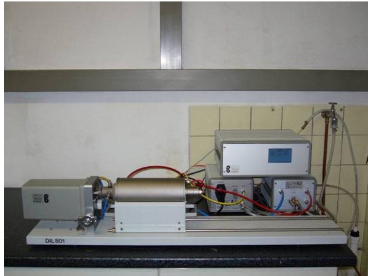
Abb. 9: Versuchsaufbau des Dilatometers DIL 801 am Institut für Gießereitechnik
