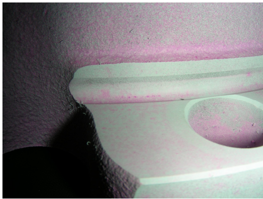
Abb. 72: 1. Serie, Versuchs-Nr. 3 (Max. Risstiefe: ca. 5,5 mm)
