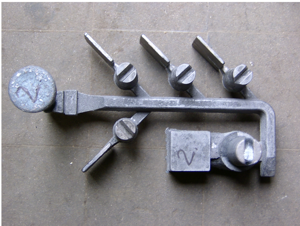
Abb. 3: Gießtraube mit Probekörpern
