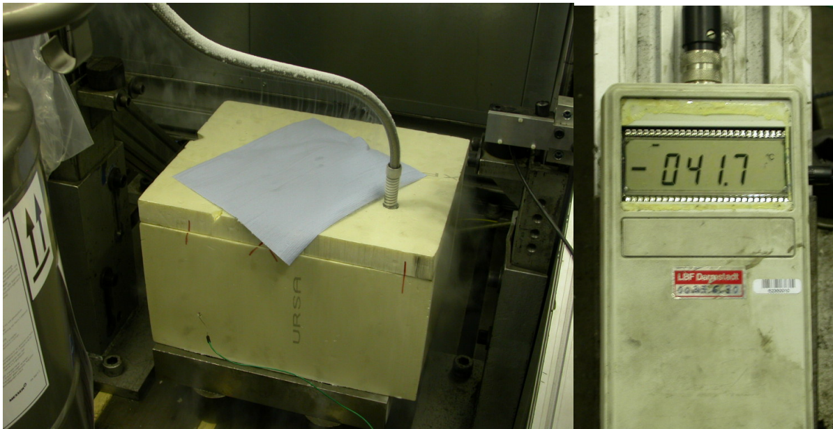
Abb. 77: Kühlkammer und Messung der Kerntemperatur
