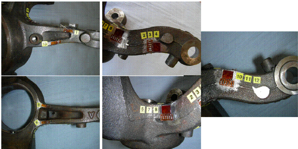
Abb. 81: Applikationsorte für die Spannungsanalyse
