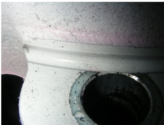
Abb. 73: 2. Serie, Versuchs-Nr. 1 (Max. Risstiefe: ca. 3,5 mm)
