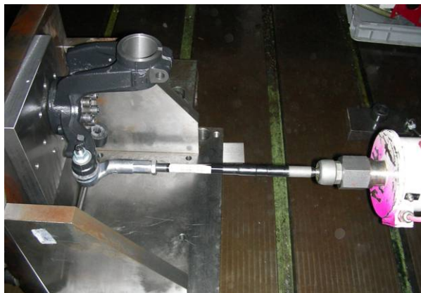
Abb. 97: Prüfaufbau für die 1-komponentige Prüfung des Spurhebels unter Betriebslast bei Audi
