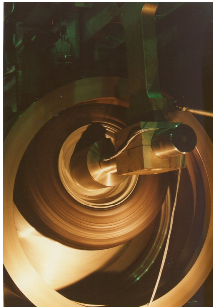
Abb. 67: ZWARP Bauart „N“ – Nfz Räder und Radnaben bis 30“ Raddurchmesser
