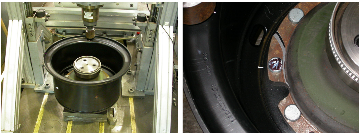
Abb. 64: Versuchsaufbau (links) und Versagen unter schlagartiger Belastung (rechts)
