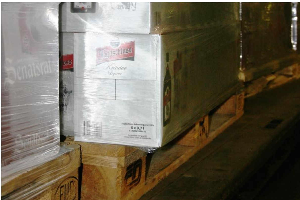
Bild 2.27: Versatz des Ladegutes vom Ladehilfsmittel
