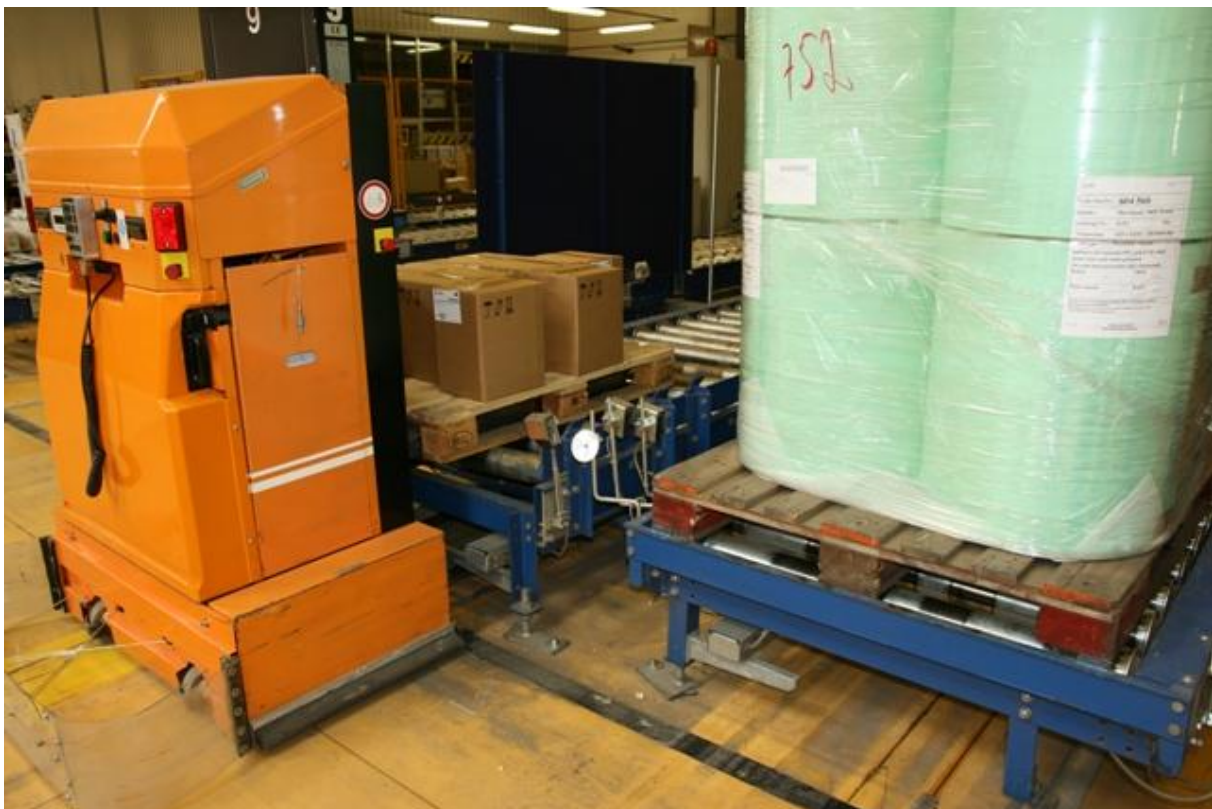
Bild 2.3: Fahrerloses Flurförderzeug bei der Lastaufnahme
