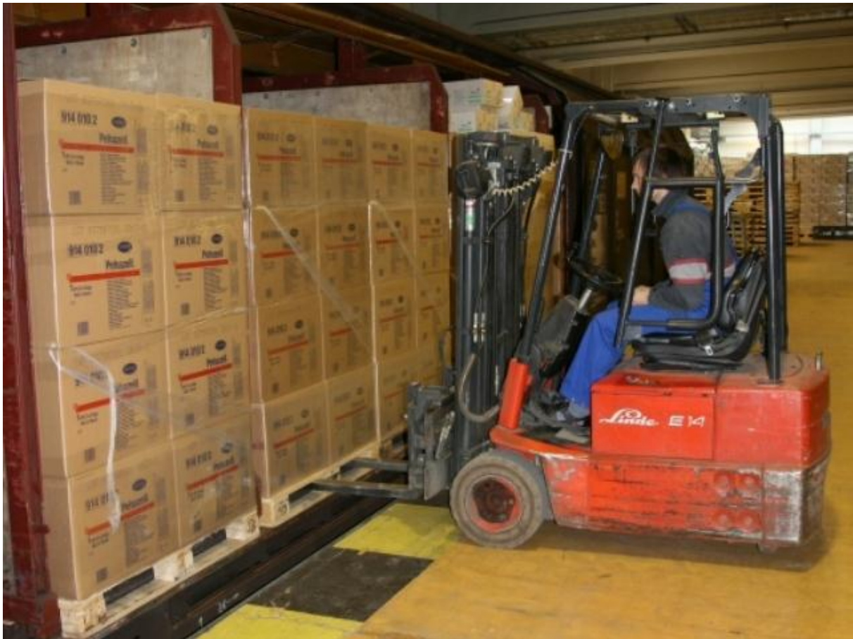
Bild 2.2: Eingesetzter Gegengewichtstapler bei der Entladung
