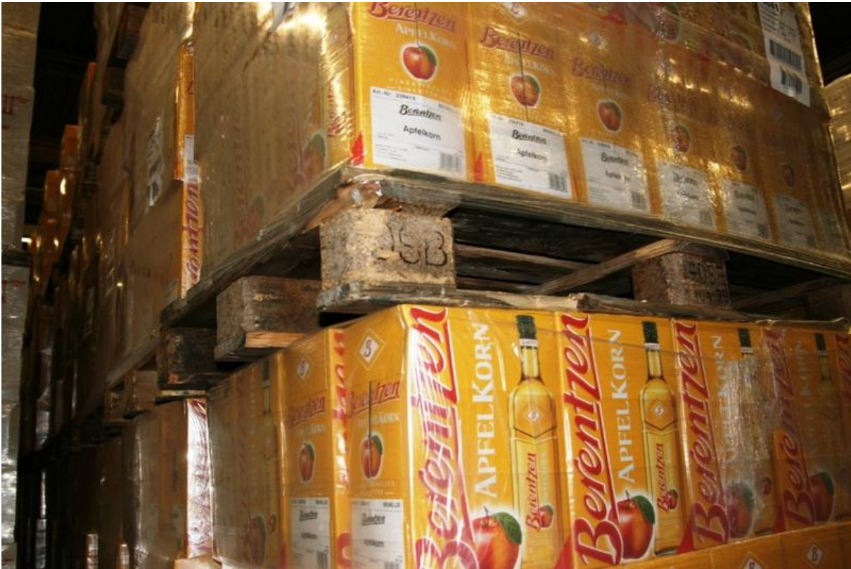
Bild 2.25: Beschädigung des Ladehilfsmittels
