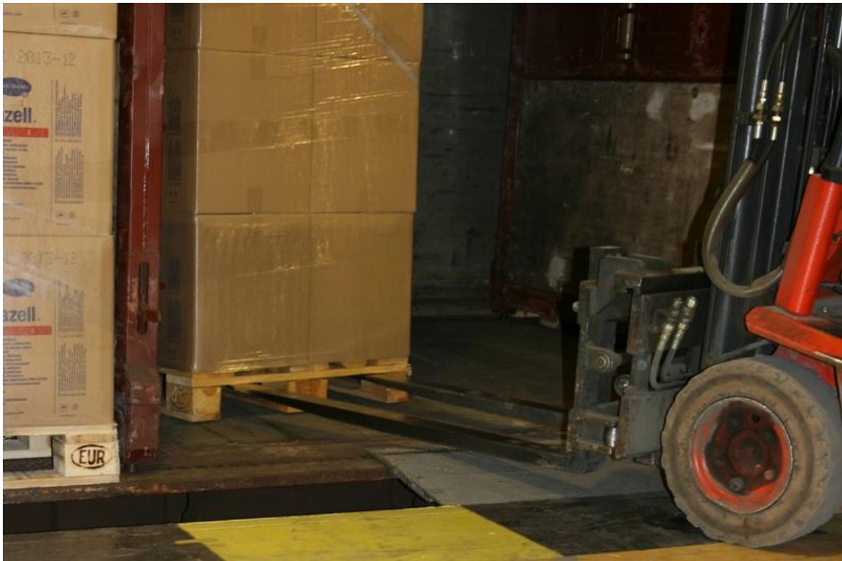
Bild 2.14: Verschieben der Ladeeinheit mit der Seitenverstelleinrichtung
