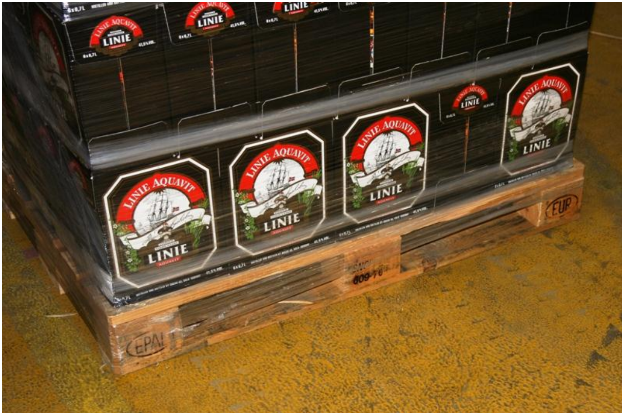
Bild 2.28: Folienüberhang beim Ladehilfsmittel
