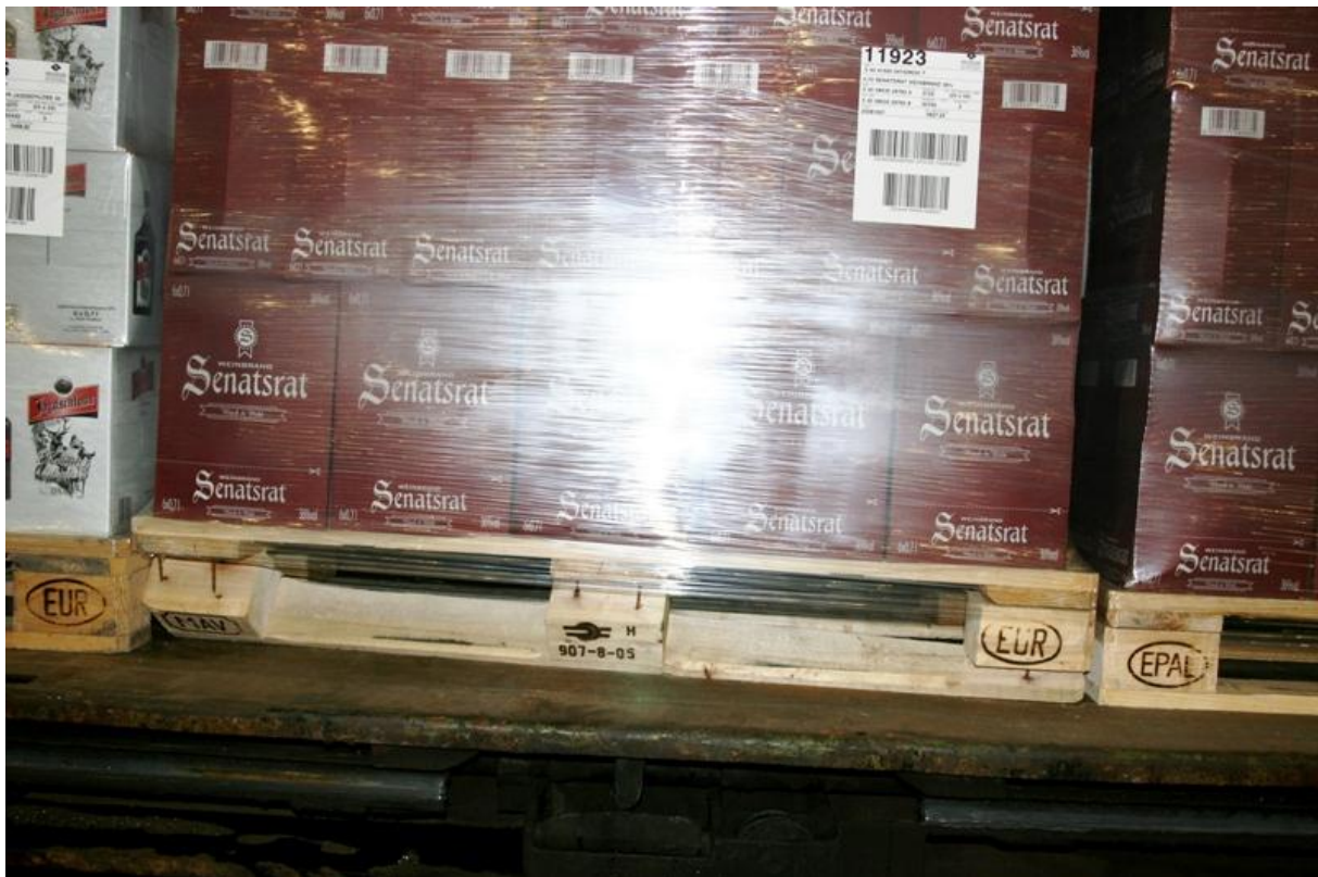
Bild 2.26: Beschädigung des Ladehilfsmittels
