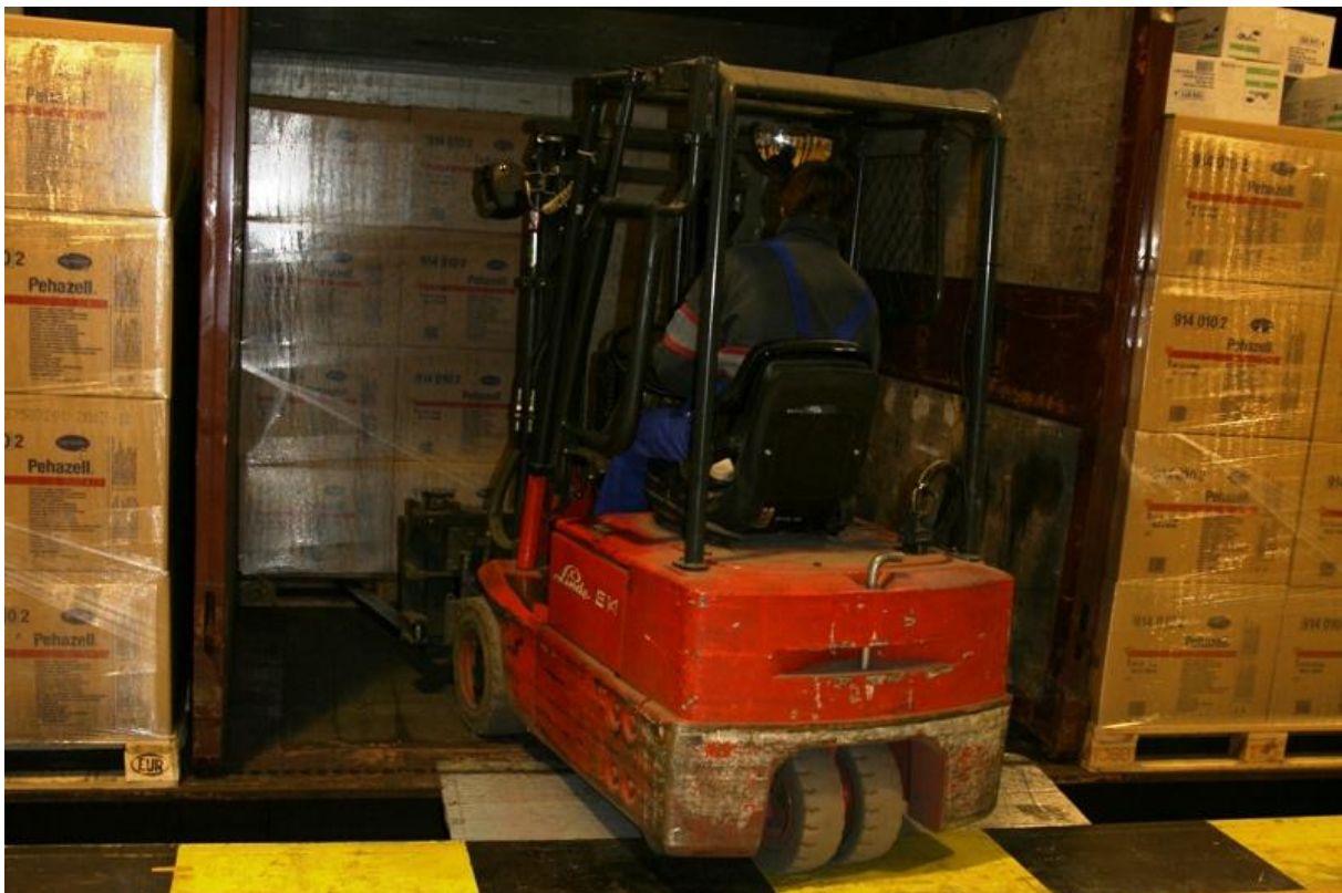
Bild 2.13: Befahren des Überladeblechs
