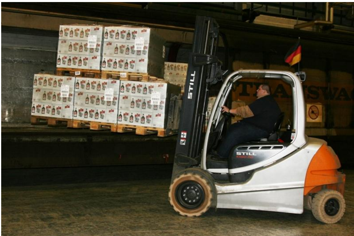
Bild 2.18: Zweifach-hohe Verbundstapelung der kleineren Ladeeinheiten
