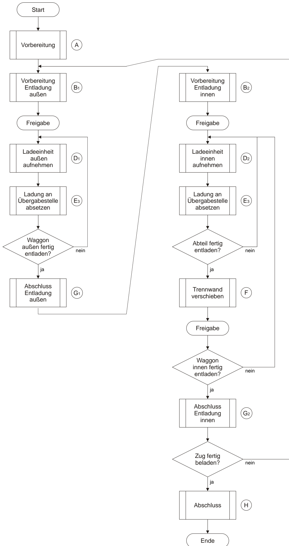
Bild 2.31: Ablauf der Entladung von innen
