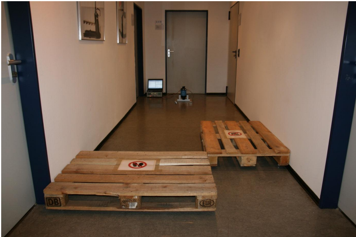
Bild 2.43: Versuchsaufbau zur Lastpositionserkennung
