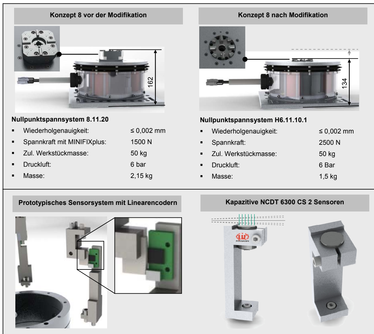
Abbildung 13: Überarbeitung der Konstruktion
