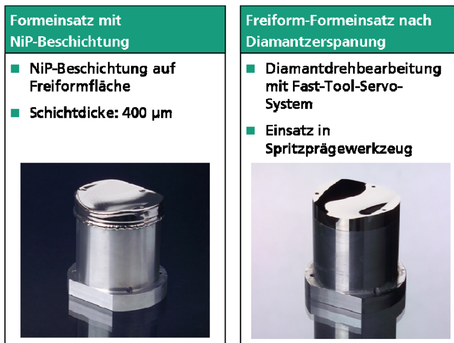
Abbildung 3: Galvanische Nickel-Phosphor-Beschichtung eines Formeinsatzes
