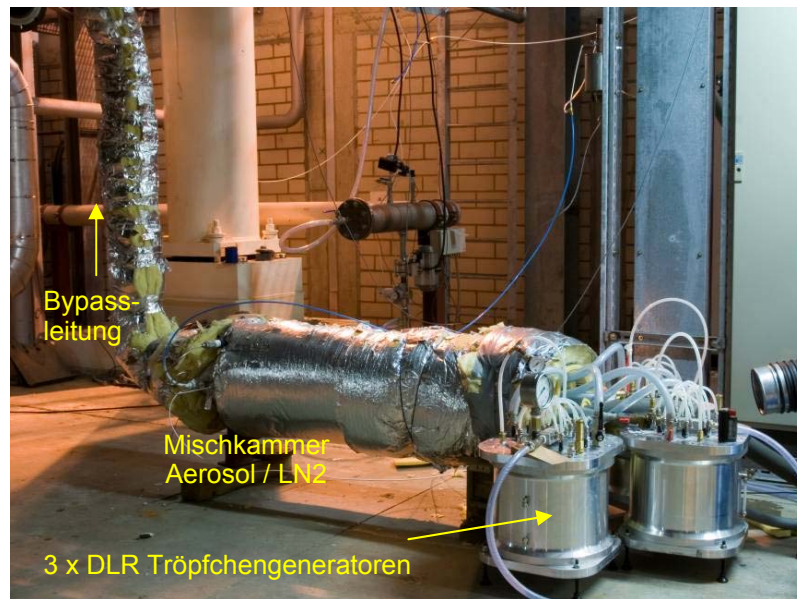
Abbildung 9: Aufbau zum Seeding des ETW mit Eispartikeln unter Verwendung der DLR Tröpfchengeneratoren.
