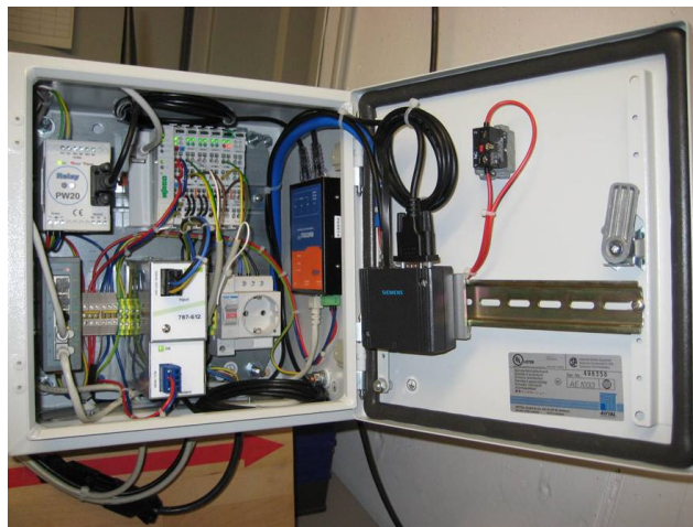
Bild 13: Messdatenerfassungssystem in der zweiten Projektphase
