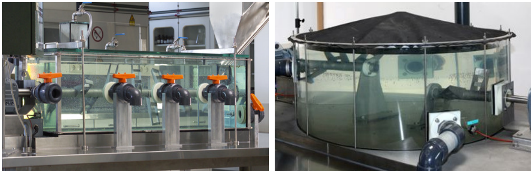
Abb. 1: Versuchsfermenter (hier in Plexiglas ausgeführt; auch baugleiche Modelle aus Edelstahl werden verwendet). Links: Technikumsfermenter Euco; Rechts: Technikumsfermenter Coccus.
