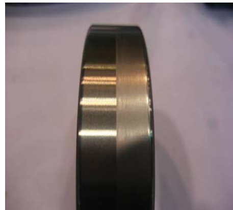
Bild 33: Versuchsdurchführung zur Messung des Abtrages am Werkstück
