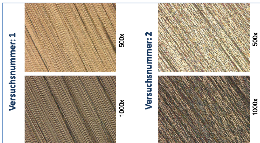
Bild 29: Vergleich der Oberflächen, links: konventionell, rechts: mit UUS
