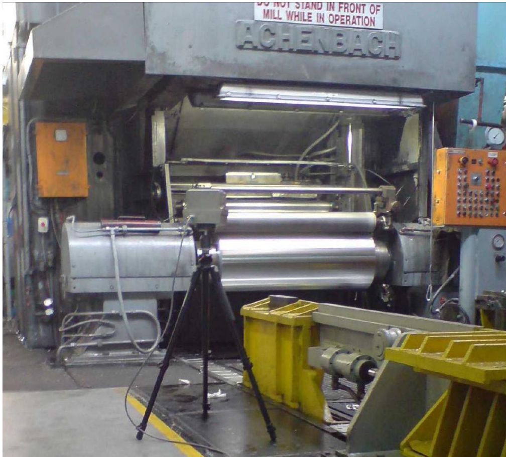
Bild 3.20: Wärmebildkamera LAND FTI-E 801 vor dem Auslaufbereich einer Walzanlage
