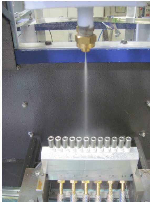
Bild 3.8: Durchführung einer Patterometermessung
