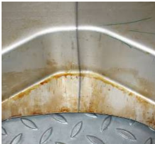
Abb. 39 Umgeformtes Bauteil mit Laserschweißnaht
