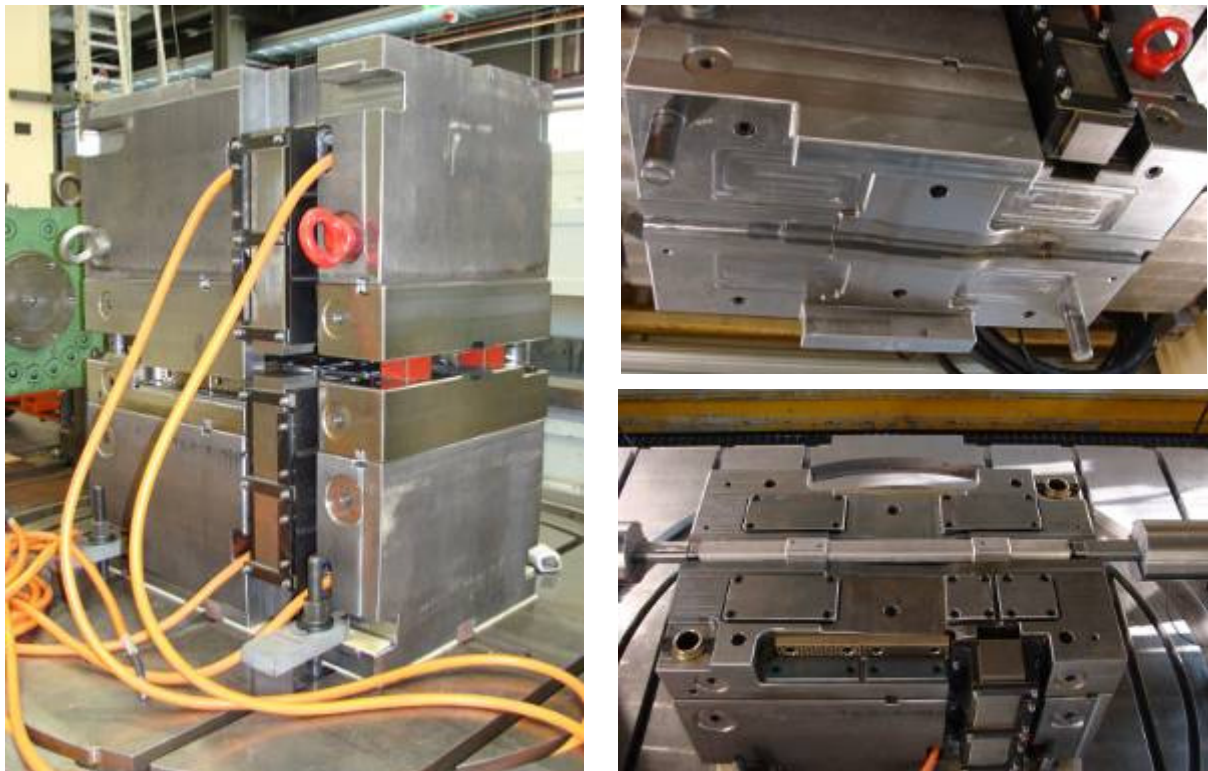
Abb. 70 TeMaK IHU-Werkzeug (links geschlossen, rechts oben Oberteil, rechts unten Unterteil mit eingelegten Einzelbauteilen)
