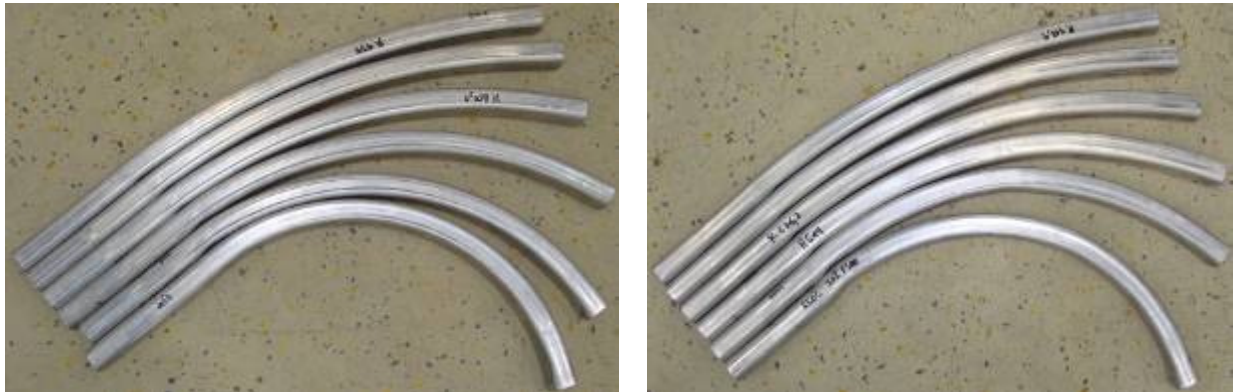
Abb. 93 Versuchsteile mit unterschiedlichen Biegeradien zur Bestimmung der Anstellwinkel sowie der technologischen Grenzen, links kalt gebogen, rechts warm gebogen
