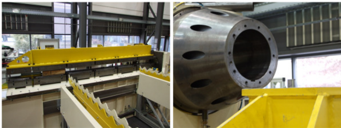
Abb. 85 Umrüstung der Gleitschienen und des Biegekopfs
