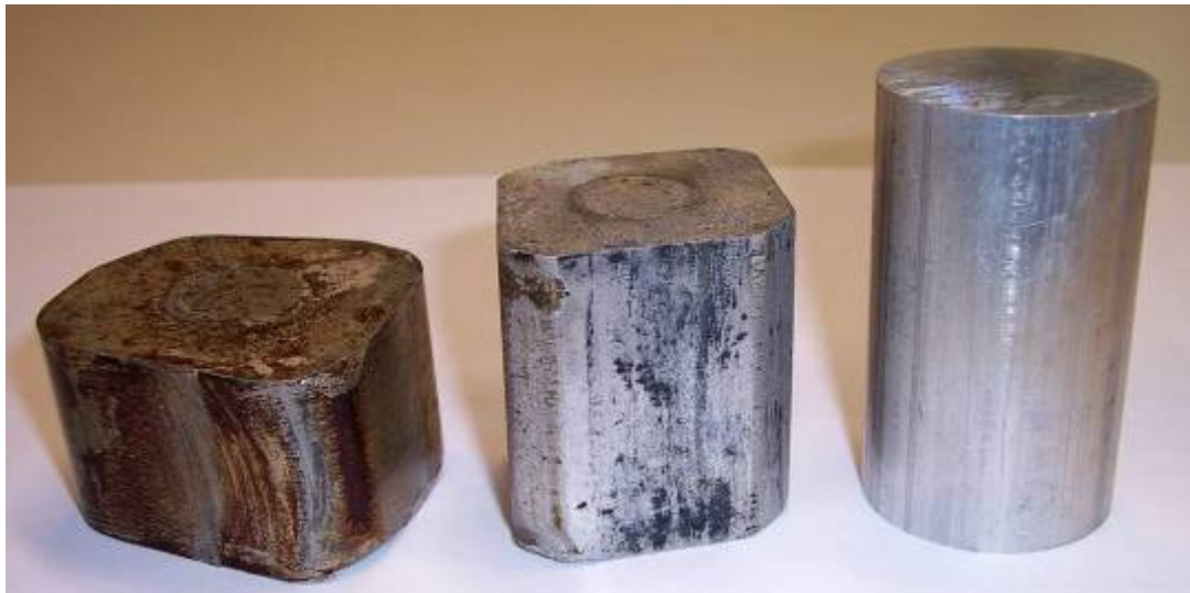
Abb. 117 Durch Prägen hergestellte Ausgangsgeometrie für das Fließpressen der Demonstratorteile (rechts: Ausgangsmaterial, mitte: Zwischenstufe, links Fertigteil)
