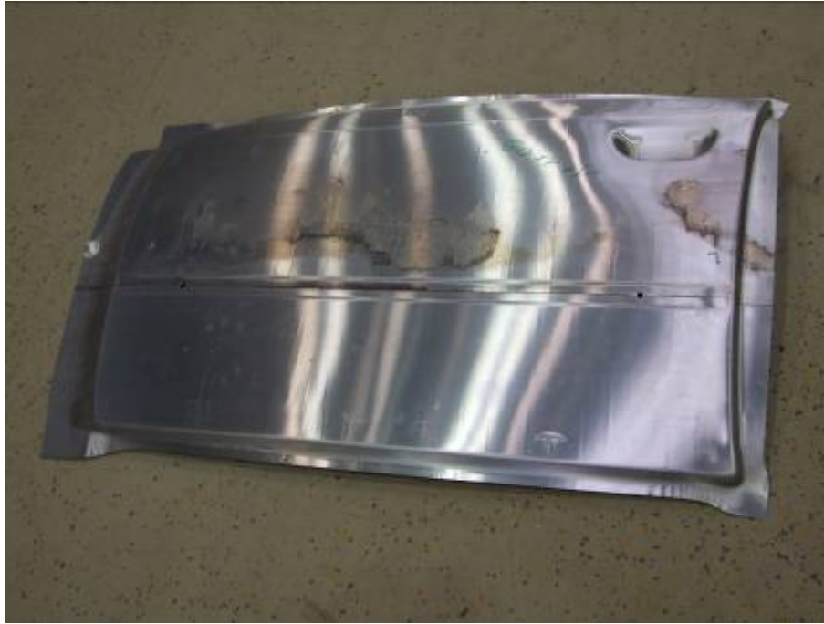
Abb. 46 Demonstrator Türaußenhaut (Ziehteil)
