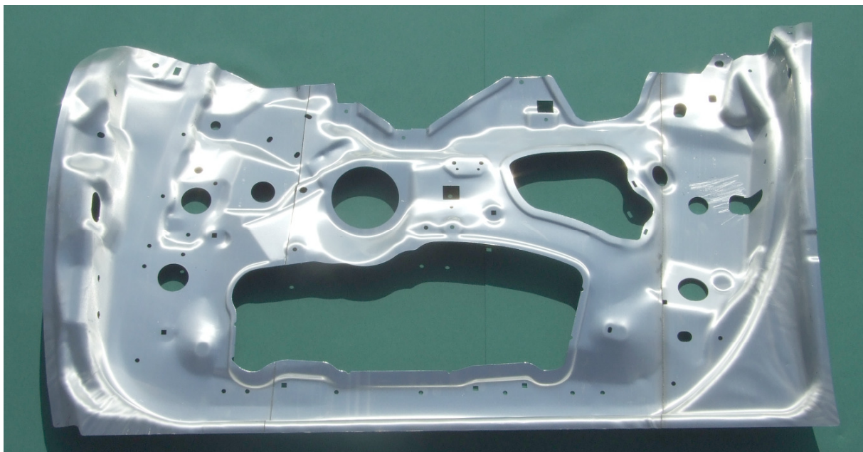
Abb. 50 Demonstrator Türinnenteil (fertig beschnitten)
