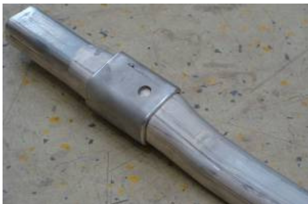
Abb. 74 Erfolgreich umgeformt und gefügtes Bauteil, Käfig auf der magnetisch erwärmten Seite aus verschiedenen Perspektiven ( 300^{\circ}\text{C} , 35 MPa)
