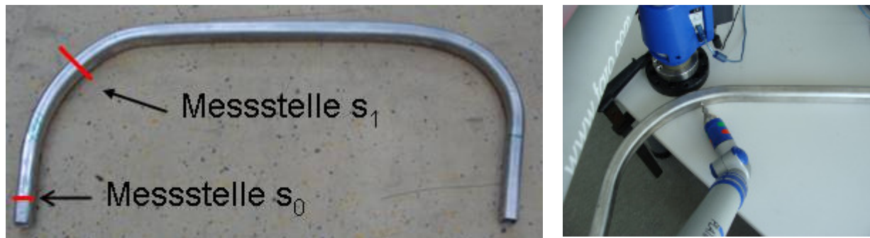
Abb. 98 Lage der Messstellen zur Bestimmung der Wanddickenverteilung (links) sowie Bauteil beim Vermessen mittels Faro Messarm (rechts)
