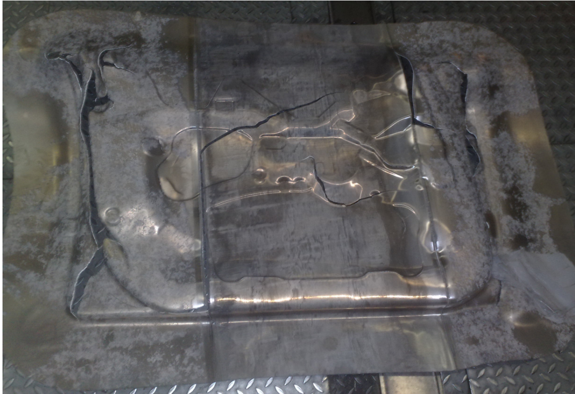
Abb. 48 Türinnenteil (mit nicht optimierter Werkzeuggeometrie gezogen)
