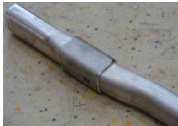
Abb. 74 Erfolgreich umgeformt und gefügtes Bauteil, Käfig auf der magnetisch erwärmten Seite aus verschiedenen Perspektiven ( 300^{\circ}\text{C} , 35 MPa)
