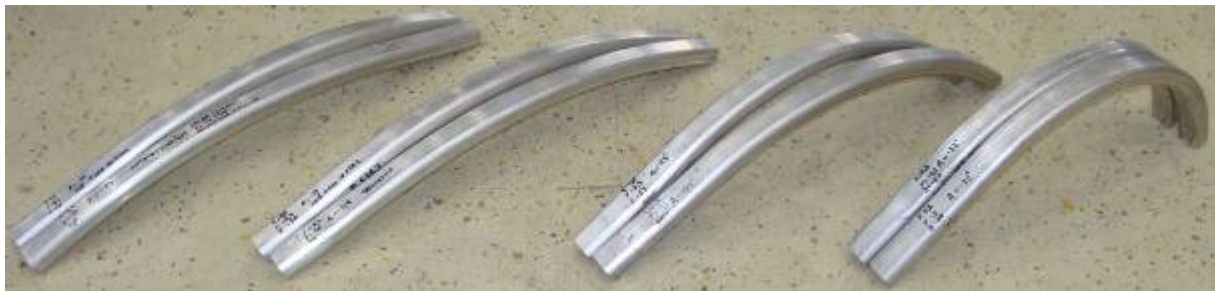
Abb. 94 Gegenüberstellung von warm (hinteres Bauteil) und kalt (vorn) gebogenen Bauteilen bei sonst identischen kinematischen Bewegungsabläufen
