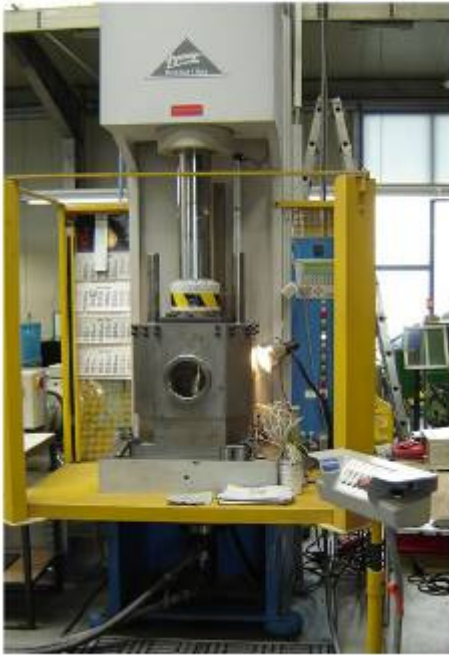
Abb. 107 Hydraulische Presse mit eingebautem Versuchswerkzeug (beheizte Matrize, beheizter Stempel)
