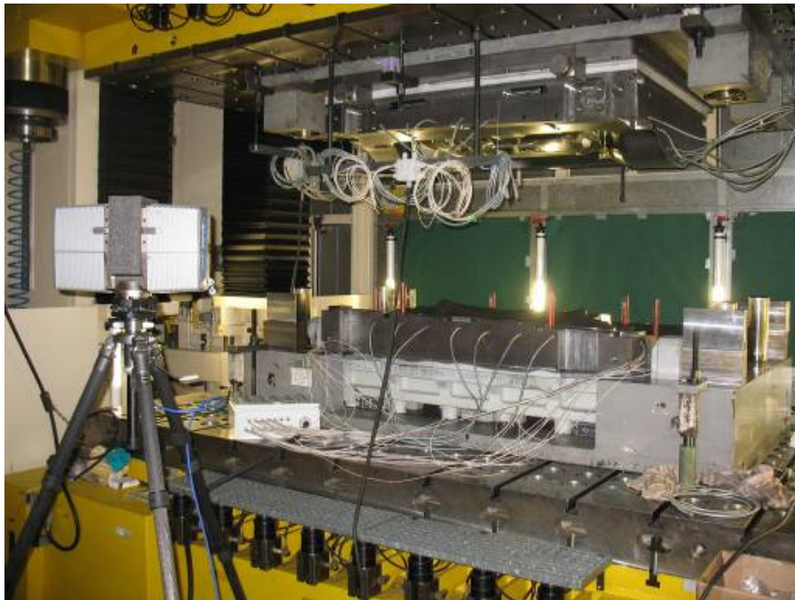
Abb. 45 beheiztes Werkzeug (Außenhaut)
