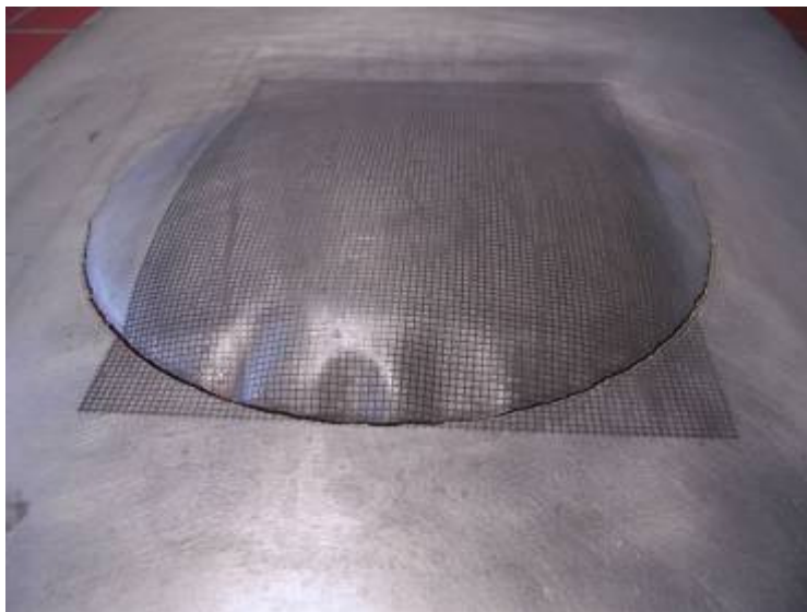
Abb. 5 Erreichte Beulhöhe an einer MBT-Probe
