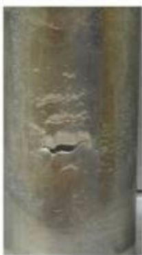
Abb. 112 Rissige Oberfläche am Fließpressteil infolge zu geringer Umformtemperatur
