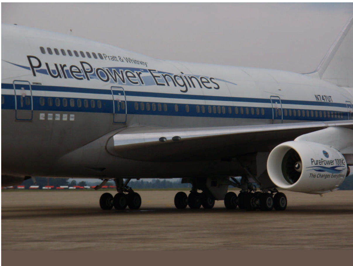
Abbildung 8: Getriebefan-Demo-Triebwerk PW1000G am Flying Testbed Boeing 747
