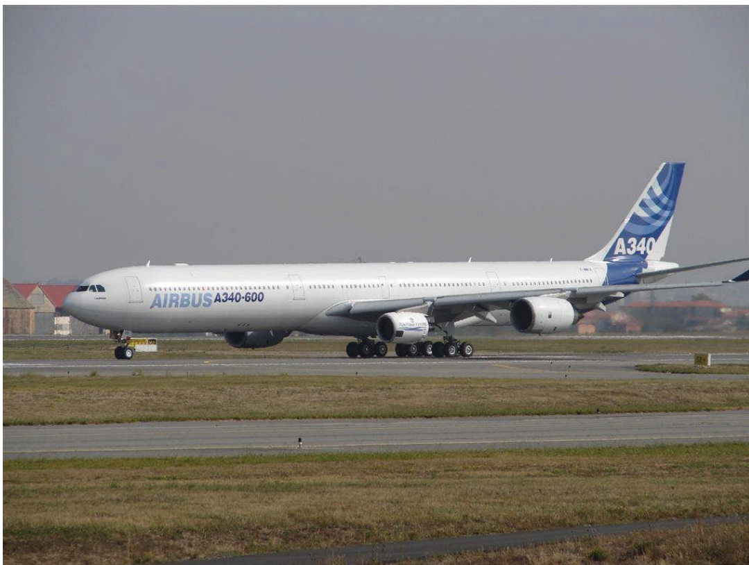
Abbildung 10: Vorbereitung zum Erstflug in Toulouse des Flying Testbed Airbus A340-600 mit dem PW1000G
