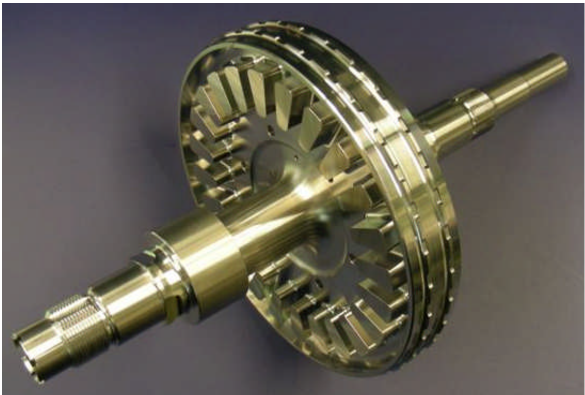
Abbildung 34: Fertiggestellter Rotor der elektrischen Maschine
