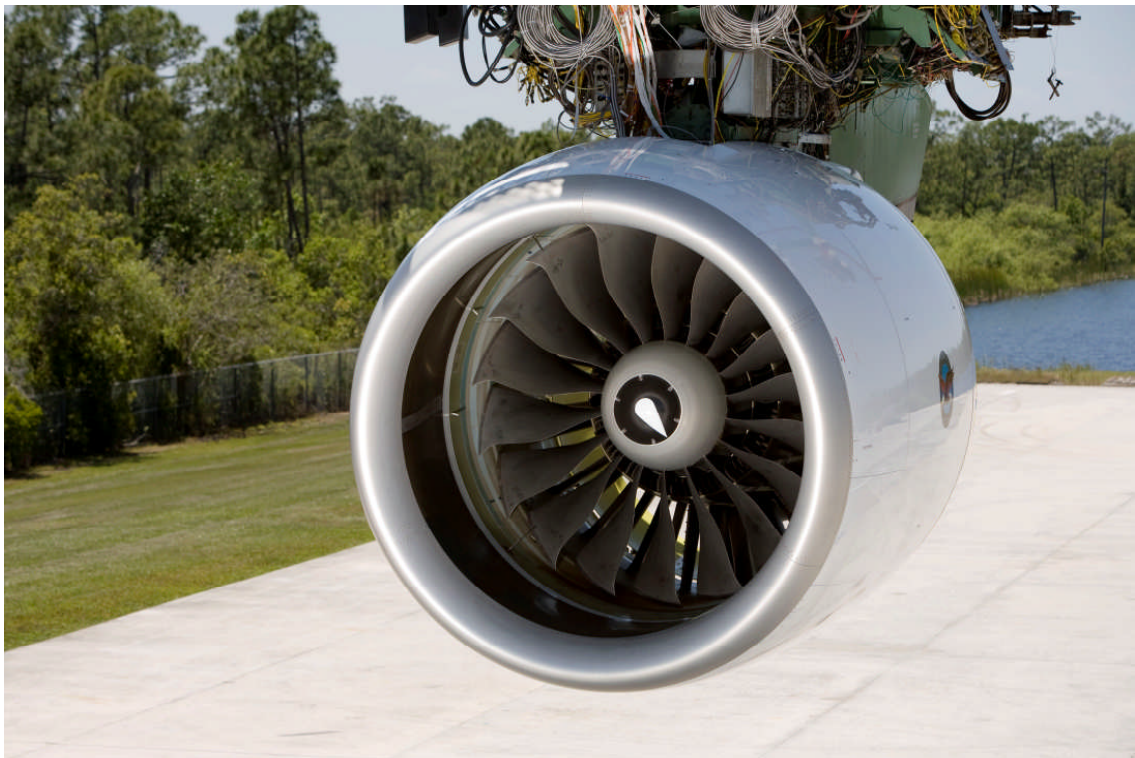
Abbildung 6: Getriebefan-Demo-Triebwerk am Pratt&Whitney-Prüfstand in Florida (USA) mit Triebwerksgondel und Einlauf für die Flugtests
