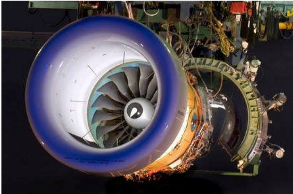
Abbildung 5: Getriebefan-Demo-Triebwerk am Pratt&Whitney-Prüfstand in Florida
