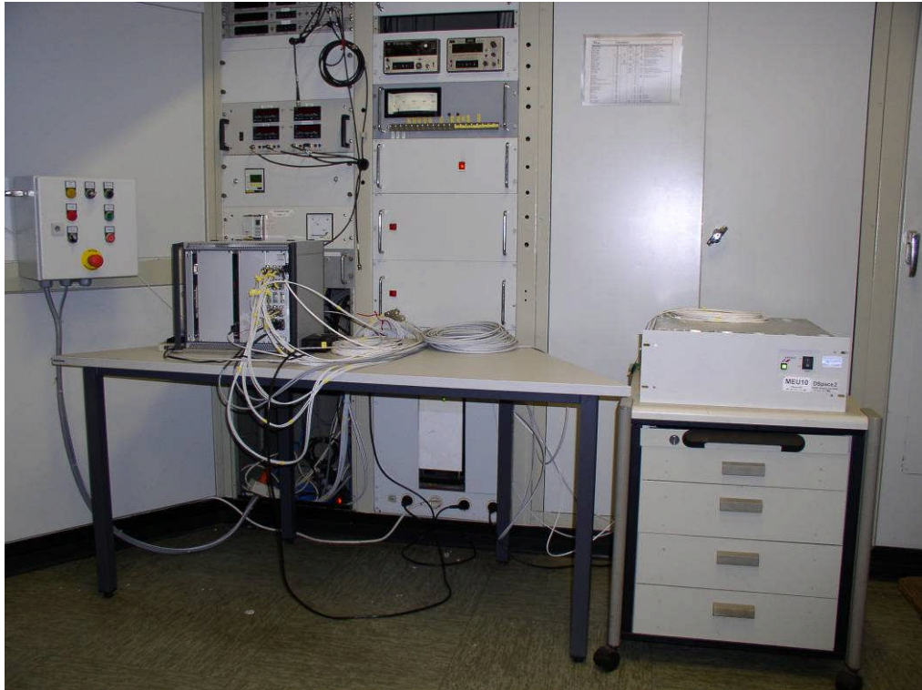
Abbildung 42: Reglereinheit (FETU + dSpace) im Leitraum
