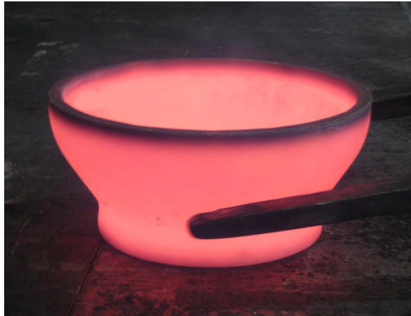
Abbildung 12: Gehäuse-Rohteil der Legierung ATI 718Plus® nach dem Schmieden
