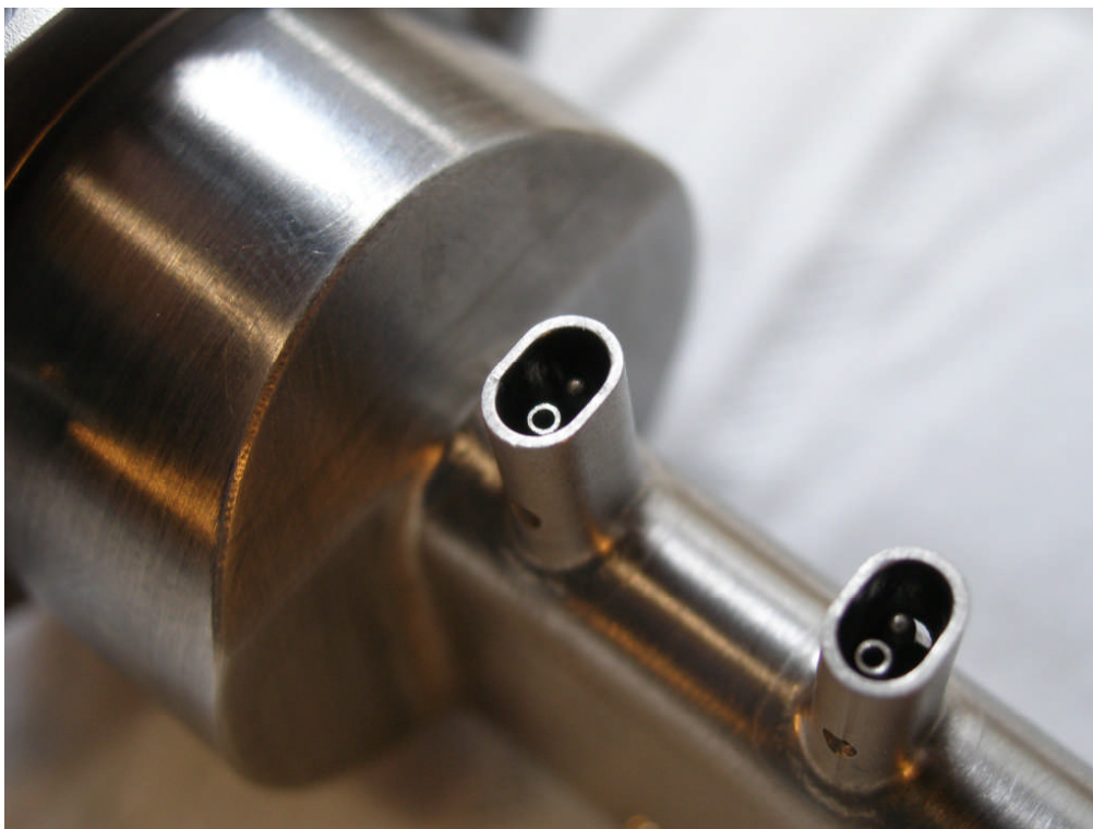
Abbildung 4: Messkiele mit Anordnung der Druck- und Temperatur-Messstelle
