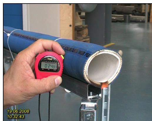
Abbildung 5.2-20: Flammability Test, Mantelfläche
