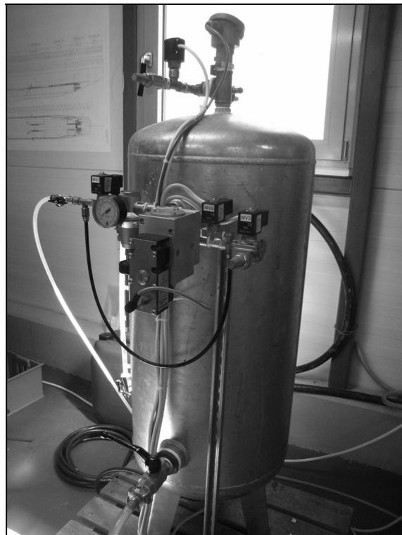
Abbildung 5.2-9: Druckwasserstation des Funktionsprüfstandes
