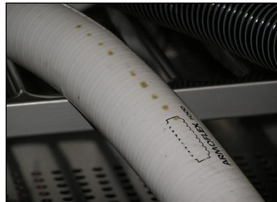
Die Versuchsreihe wurde anschließend mit einem Endurance Test erweitert und eine Toilette der Firma AOA mittels Schlauch an das Hauptrohrsystem angeschlossen. Ziel war es zu prüfen ob die unterschiedlichen Schläuche den Anforderungen im Dauerbetrieb standhalten können und es nicht zu Beschädigungen oder Rissen kommt. In den folgenden Bildern ist der Testaufbau für diese Untersuchung zu sehen.
