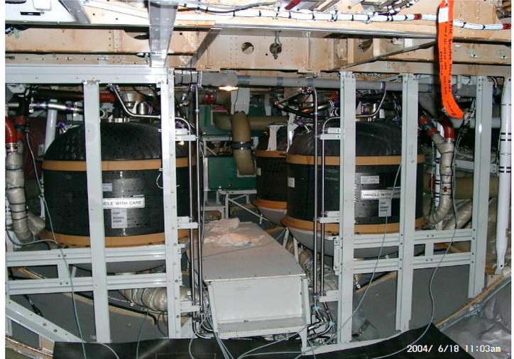
Abbildung 4-2: Tankmodul und Integrationsraum im 340-500/-600
