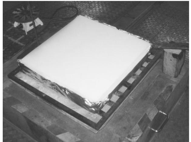
Abbildung 5.3-10: Testaufbau für die Testfeuer TF4 und TF5 der EN54-7
