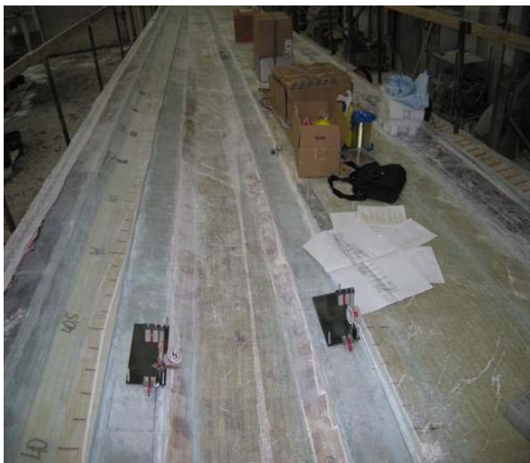
Abbildung 3-4: Fasersensor-Einbettung in ein 56 m langes Rotorblatt.
