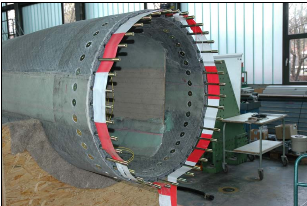
Abbildung 4-33: Ersatz-Rotorblatt (IKEA-Blattanschluss mit 40 Schraubbolzen)
