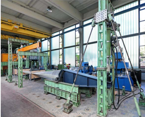
Abbildung 3-30: Rotorblattversuchsstand in der BAM mit montiertem Ersatzrotorblatt.
