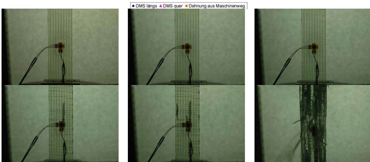
Abbildung 6-21: Spannungs-Dehnungs-Diagramm der 0°-UD-Probe, Bilder bei 0,0 %-, 0,5 %, 1,0 %-, 2,23 %- 2,36 %-Dehnung und nach Probenbruch aufgenommen
