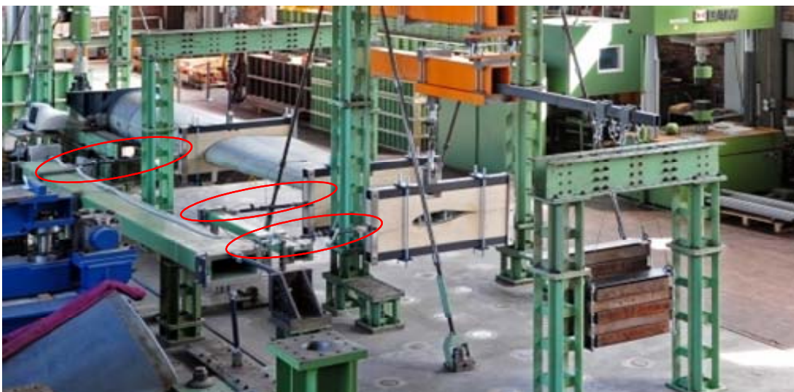
Abbildung 4-37: Koppelstangen des Prüfstandes zur Einleitung der drei Kräfte für die Schwenklast (siehe Markierungen)
