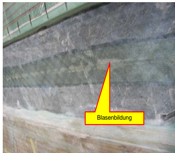
Abbildung 3-5: Blasenbildung im Bereich der Sensorfasern.
