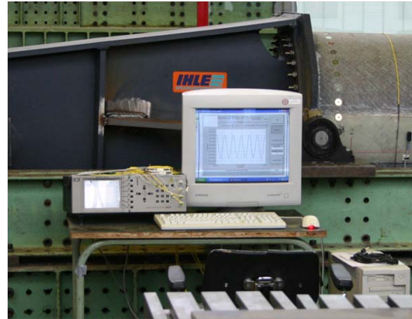
Abbildung 3-31: Faseroptisches Messsystem zur Aufzeichnung der Messdaten der werkstoffintegrierten FBG und der oberflächlich applizierten FBG-Patches.
