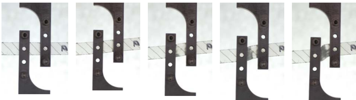
Abbildung 6-18: Schubversuch in der Instron-Prüfmaschine – Probenphotos in verschiedenen Prüfstadien
