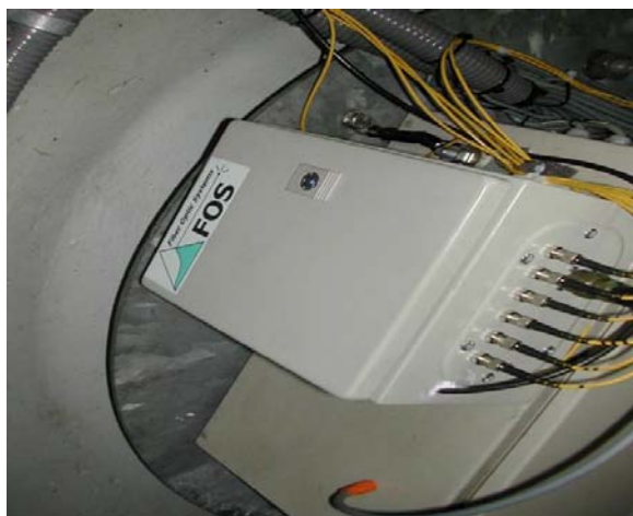
Abbildung 7-38: Modulics opto-elektronische Einheit in rotierender Nabe
