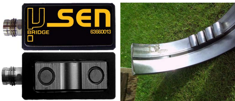
Abbildung 1-8:: Körperschallsensor „ \mu -Bridge“ <Bild links>; Mit „ \mu -Bridge“ eindeutig und frühzeitig detektierter Hauptlagerschaden <Bild rechts>
