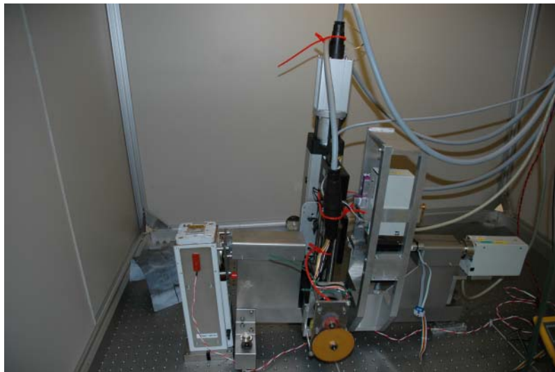
Abbildung 6-15: Röntgenrefraktionsanlage mit integrierter Minimat-Zugprüfmaschine
