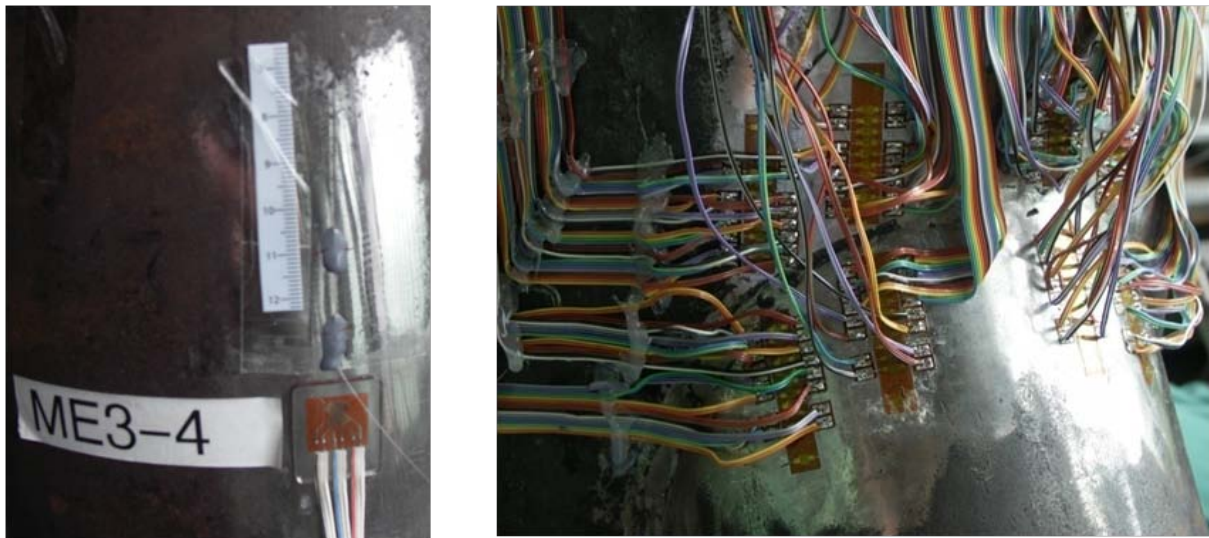
Abbildung 7-11: Faseroptischer Sensor und DMS – Rosette (links) und DMS Ketten am Hot Spot (rechts)
