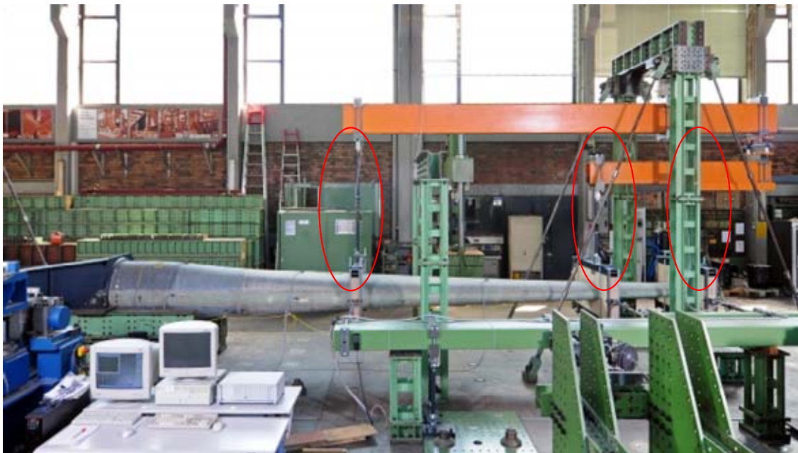
Abbildung 4-36: Koppelstangen des Prüfstandes zur Einleitung der drei Kräfte für die Schlaglast (siehe Markierungen)
