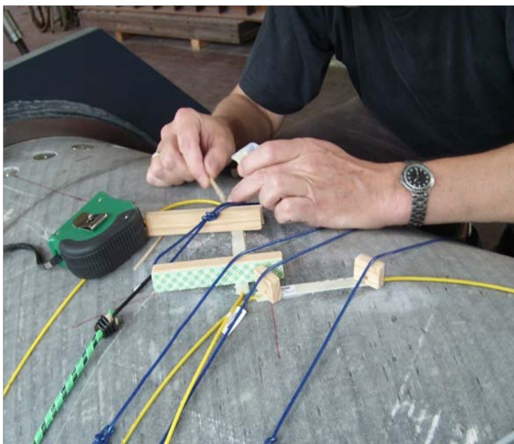
Abbildung 3-29: Nachapplikation von Sensorpatches auf dem Versuchsflügel im Rotorblattversuchsstand der BAM.
