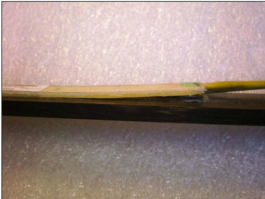
Abbildung 3-26: Delamination zwischen FGB-Patch und FVW-Probe
