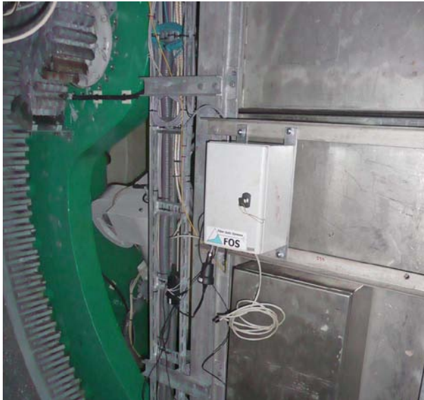
Abbildung 1-12: Opto-elektronische Auswerteeinheit MODULICS in der Nabe der M5000_2
