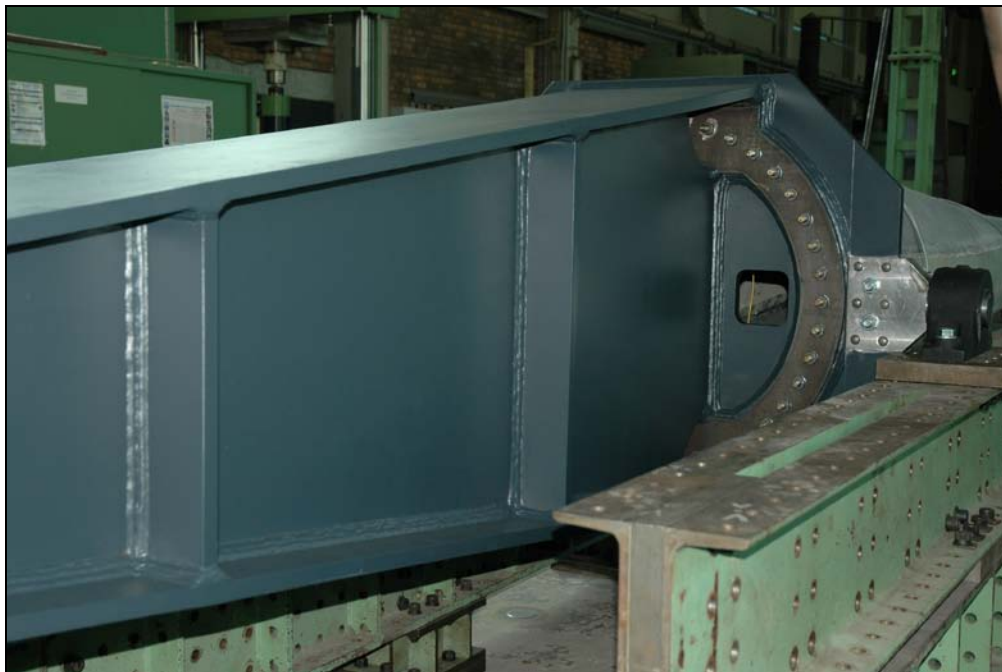
Abbildung 4-34: Stellvertreter-Prüfstand (Hebel zur Einleitung der Schlaglast)
