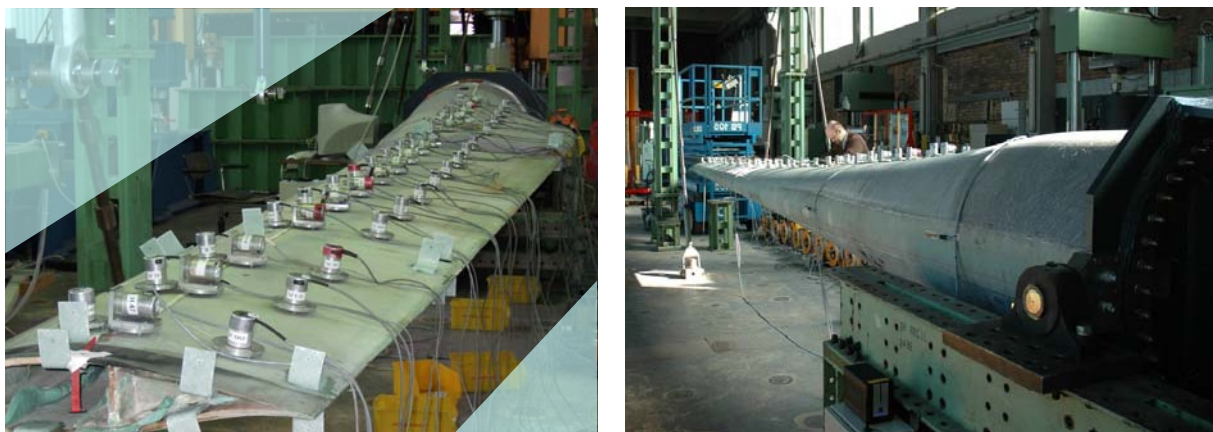
Abbildung 4-48: Ersatz-Rotorblatt mit Geophonen von BAM-VII.2
