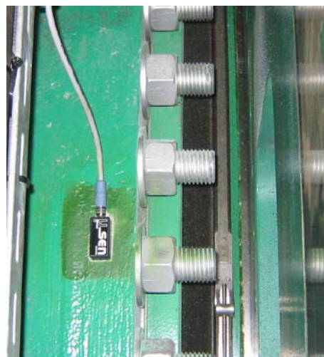
Abbildung 1-9: Tripod-Fundament M5000_2 <Bild links>; „ \mu -Bridge“ am Rotorlager der Offshore WEA M5000_2 <Bild rechts>
