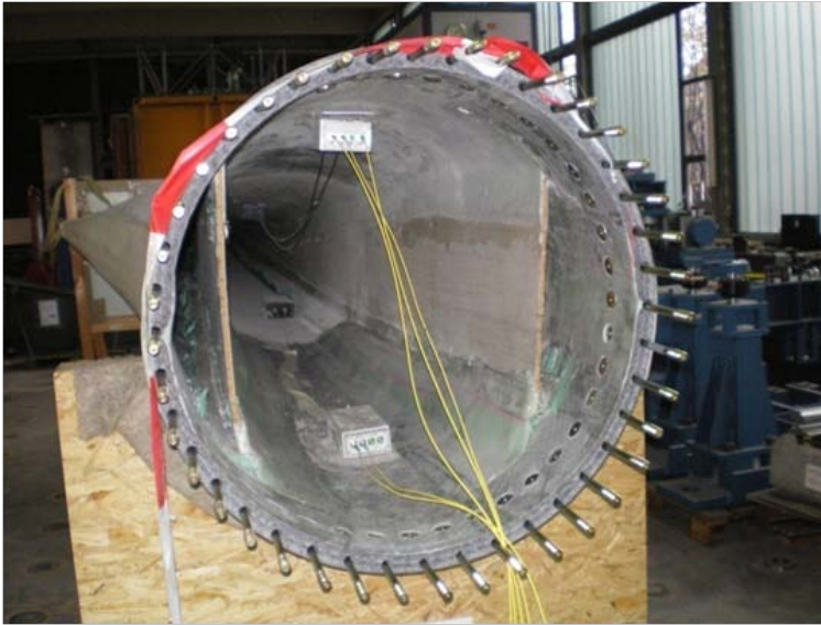
Abbildung 3-28: Stellvertreterrotorblatt mit angeschlossenen Sensoren bei einer Kontrollmessung.
