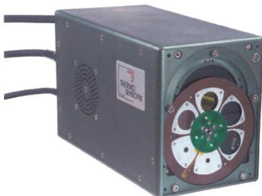
Abb. 2: Kamerakopf CMT 256 mit integriertem Filterrad. Filtertemperatur, Gehäusetemperatur und Objektivtemperatur (Objektiv nicht dargestellt) können unabhängig voneinander kontinuierlich gemessen werden.
