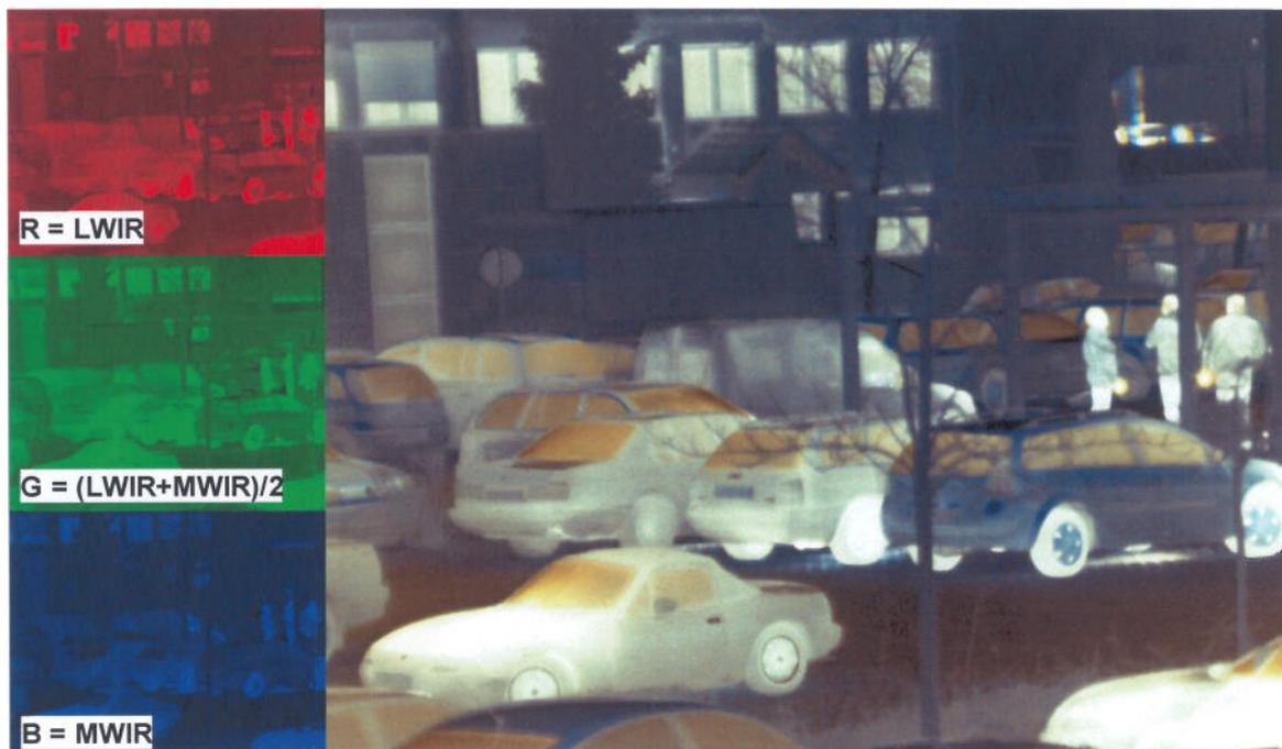
Abb. 5: Umsetzung einer Zweifarben-Aufnahme in eine farbige Darstellung im RGB-Modus. Der dritte Farbkanal (grün) wurde durch den Mittelwert der beiden belegten Kanäle belegt. Durch diese Auswahl erscheinen Bereiche, die in den beiden belegten Kanälen die gleichen Intensitäten aufweisen, als Graustufen.
