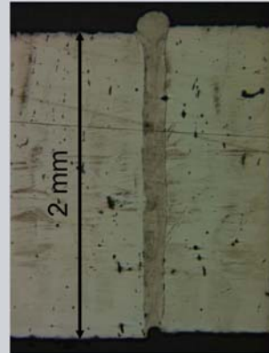
Bild 3.48: Schwer schweißbare Materialien und Materialkombinationen
