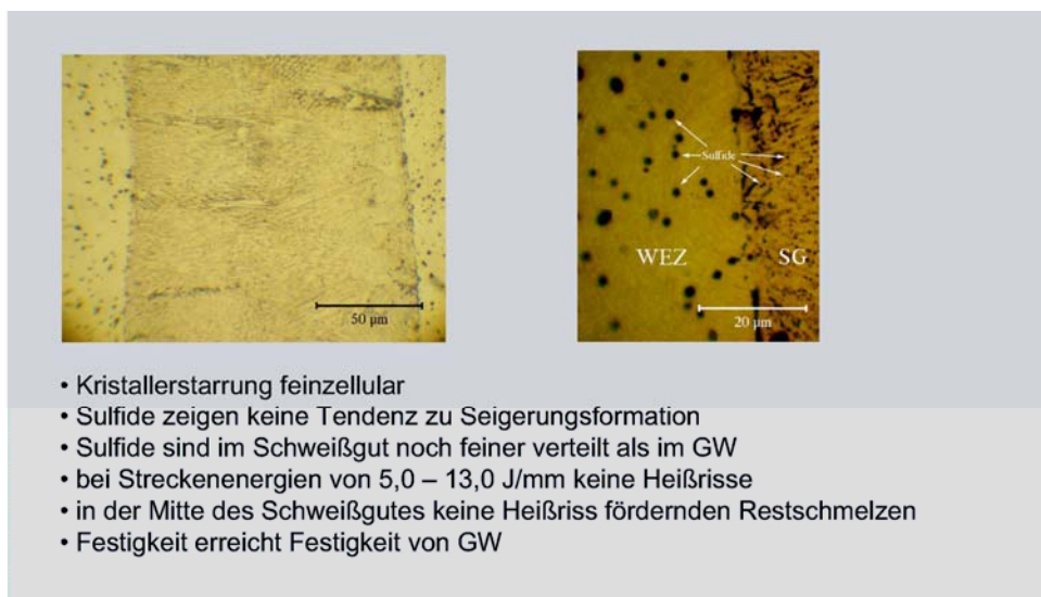
Bild 3.52: Gefügestruktur im Bereich der Schweißnaht an Proben aus gewalztem Flachmaterial
