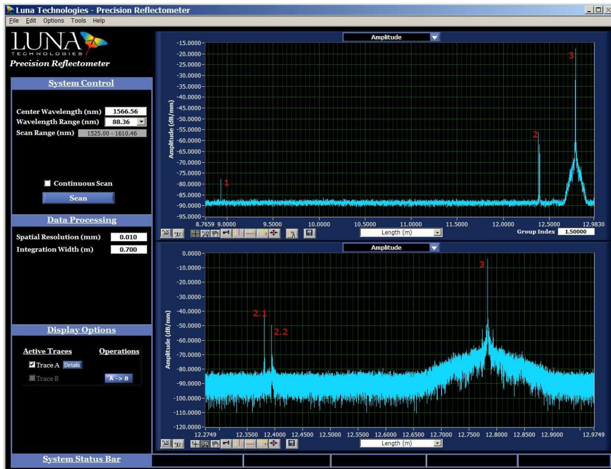
Abbildung 1.5: Vermessung der Passiven Dose P1 mit dem Präzisionsreflektometer
