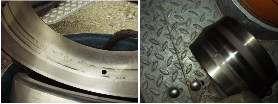
Abbildung 96: Außenringschaden QJ- Lager / Innenringschaden des QJ- Lagers
