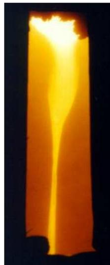
Abbildung 2.3: Prinzip der Schmelzfeuerung in U-Form
