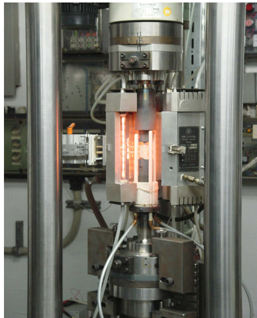
Bild 3: Prüfaufbau einer servohydraulischen Prüfmaschine zur Durchführung dehnungsgeregelter Ermüdungsversuche (mit Seitenextensometer für den axialen Dehnungsabgriff) und kraft geregelter Ermüdungsversuche
