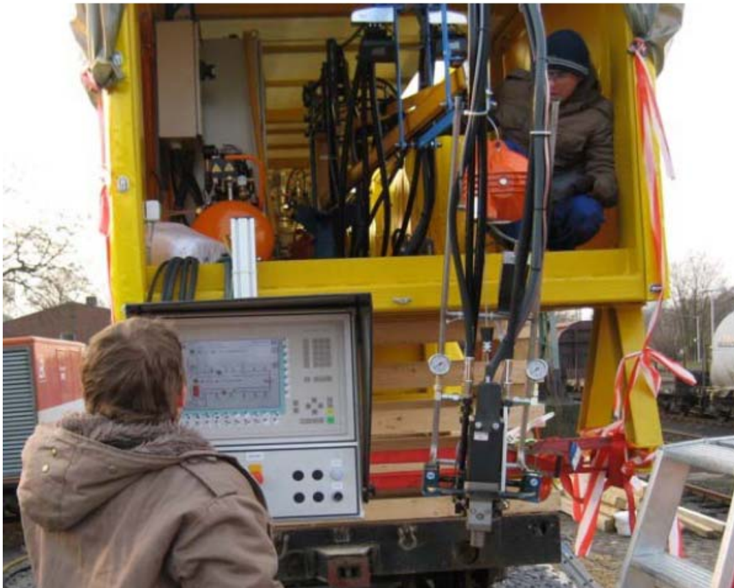
Abbildung 11: Spritzkopf und Wintronic-Steuerung der Dosiermaschine
