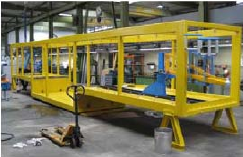
Abbildung 10: „Container“-Konstruktion zur Aufnahme der Hochdruck-Dosiermaschine
