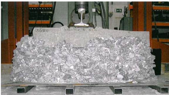
Abbildung 3: Probekörper Quelle: MPA TU Braunschweig(2006) Prüfbericht Dauerschwellenversuch
