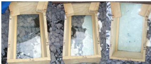
Das Verschäumergebnis Glasschwelle
