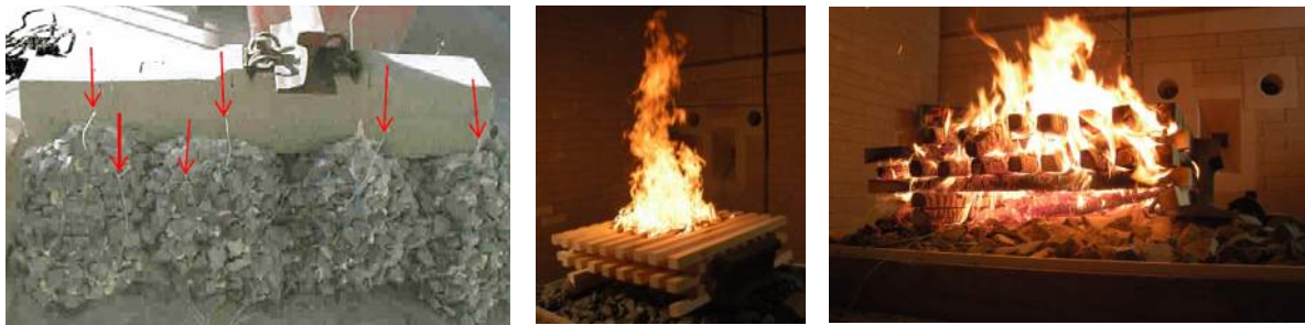
Abbildung 7: Messstellen zur Temperaturmessung und Bilder des Brandversuches Quelle: MPA TU Braunschweig(2007), Brandversuche
