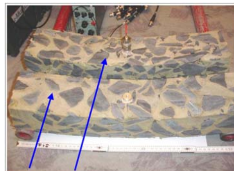
Probekörper K1 und Probekörper K1+32 Abmaße: 10 x 10 x 50 cm. als Biegebalken aufgelegt. Einfeldträger mit 48 cm Tragweite, Rohre dienen dabei als zwingungsfreies Auflager.
