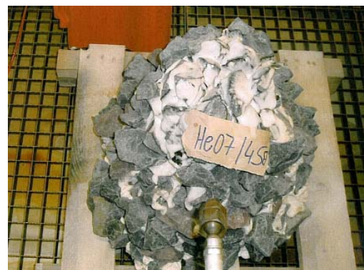
Abbildung 8: DURFLEX® Schotterkegel, Frostversuche Quelle: MPA TU Braunschweig (2007)
