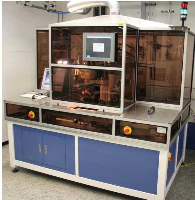
Abbildung 15: Fertigungstaugliche Entwicklungsanlage für Diffusionslötverbindungen.
