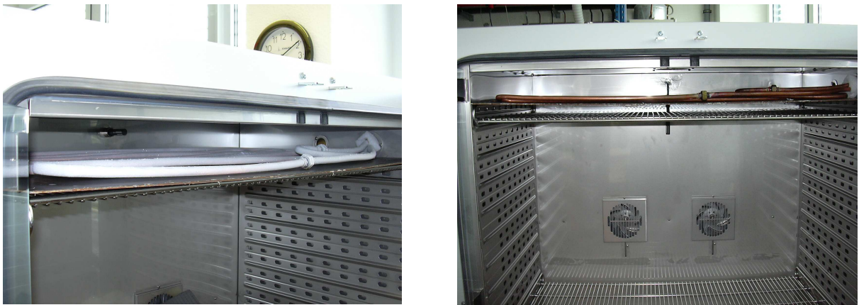
Abbildung 13: Modifikation der Klimakammer. Die eingebaute Stahlplatte kann durch Kupferrohre mittels der Reihenschaltung zweier Laborthermostate auf -10\text{ °C} abgekühlt werden, um kalte atmosphärische Schichten zu simulieren.
