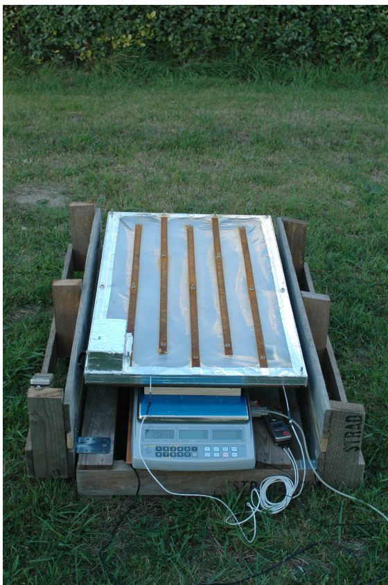
Abbildung 22: Messaufbau von Spätsommer 2009. Links: Wassersammler; rechts: Wetterstation
