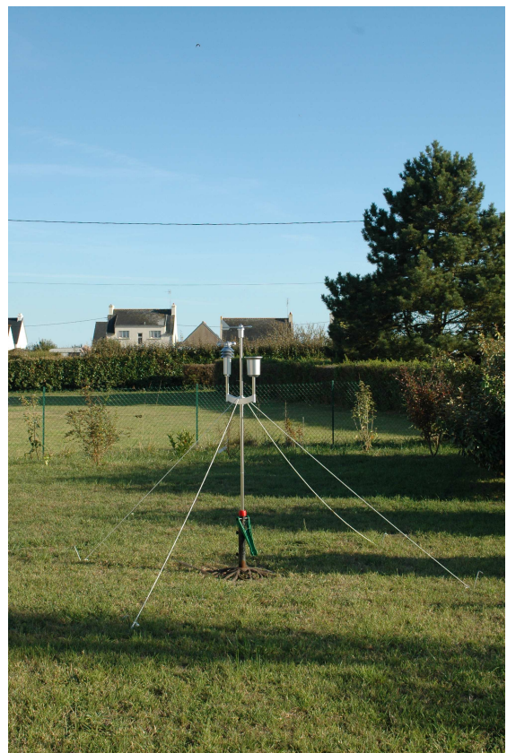
Abbildung 22: Messaufbau von Spätsommer 2009. Links: Wassersammler; rechts: Wetterstation
