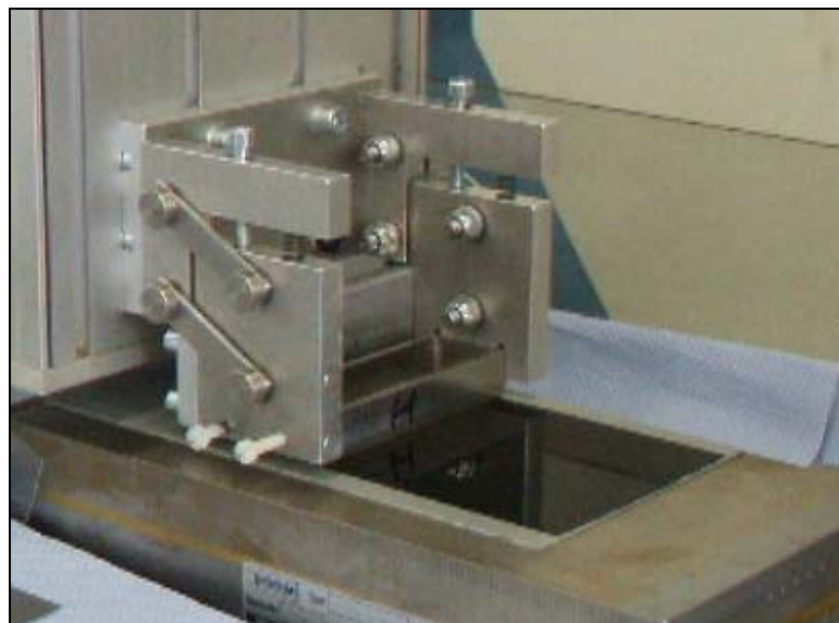
Abbildung 5, Lackapplikation mit Filmziehgerät
