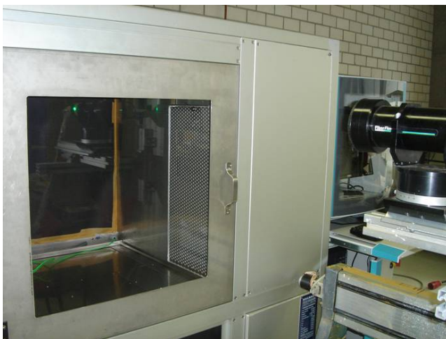
Abbildung 1 und 2: Hygrex-Trockner mit Laser-Doppler Optik und Ergebnis einer Simulation der Trocknerinnenströmung, dargestellt anhand von 5 parallelen Ebenen
