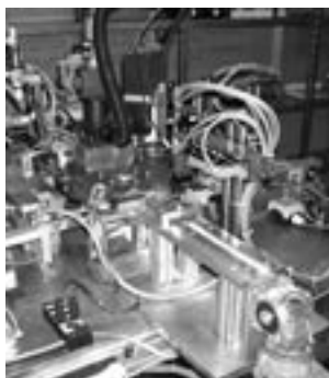
Bild 4 // Entwicklung und Bau einer automatischen Fertigungsanlage mit Laserschweißstation und entsprechender Sensorik (Feinwerkmechaniker)
