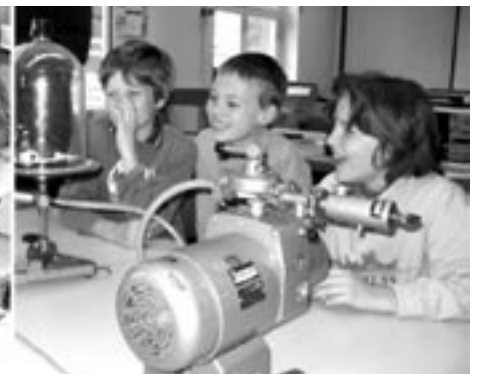
Bild 2 // Experiment zum Luftdruck im Grundschülerlabor; der Mohrenkopf platzt im Vakuum durch seinen Innendruck.
