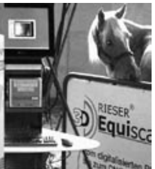
Bild 3 // Digitale 3D-Laservermessung eines Pferderückens zur Fertigung eines Maßsattels (Sattler)
