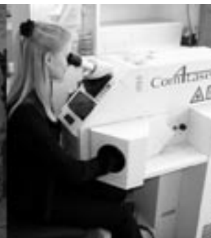
Bild 2 // Laser-Reparaturschweißen einer Zahnprothese (Zahntechniker)
