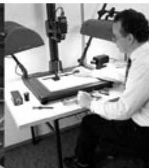
Bild 5 // Versuchsstand zur Optimierung eines optischen Fehlererkennungssystems und anschließende Integration in eine Produktionsanlage (Elektrotechniker)
