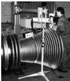
Bild 1 // Laser-Reparaturschweißen eines Dampfturbinenläufers mit einem Laser-Handarbeitsplatz (Feinwerkmechaniker)
