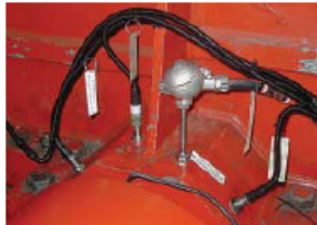
Ein typisches Beispiel für die Montage von Sensoren an einer Maschine.
