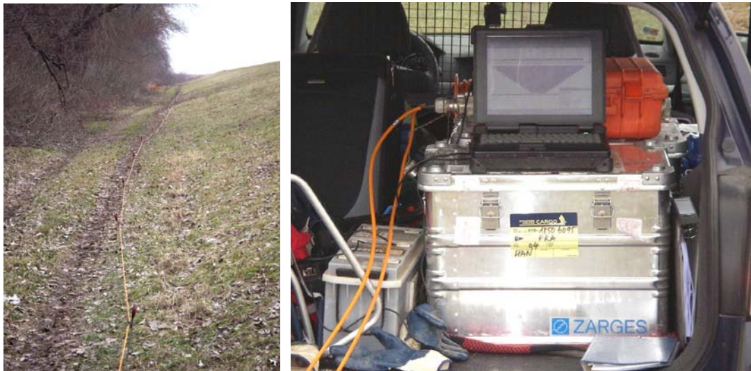
Abbildung 17: Nördlicher Messabschnitt in der Nähe des Versuchsbrunnens mit Messauslage (links) und Messwertaufnahmesystem (rechts)
