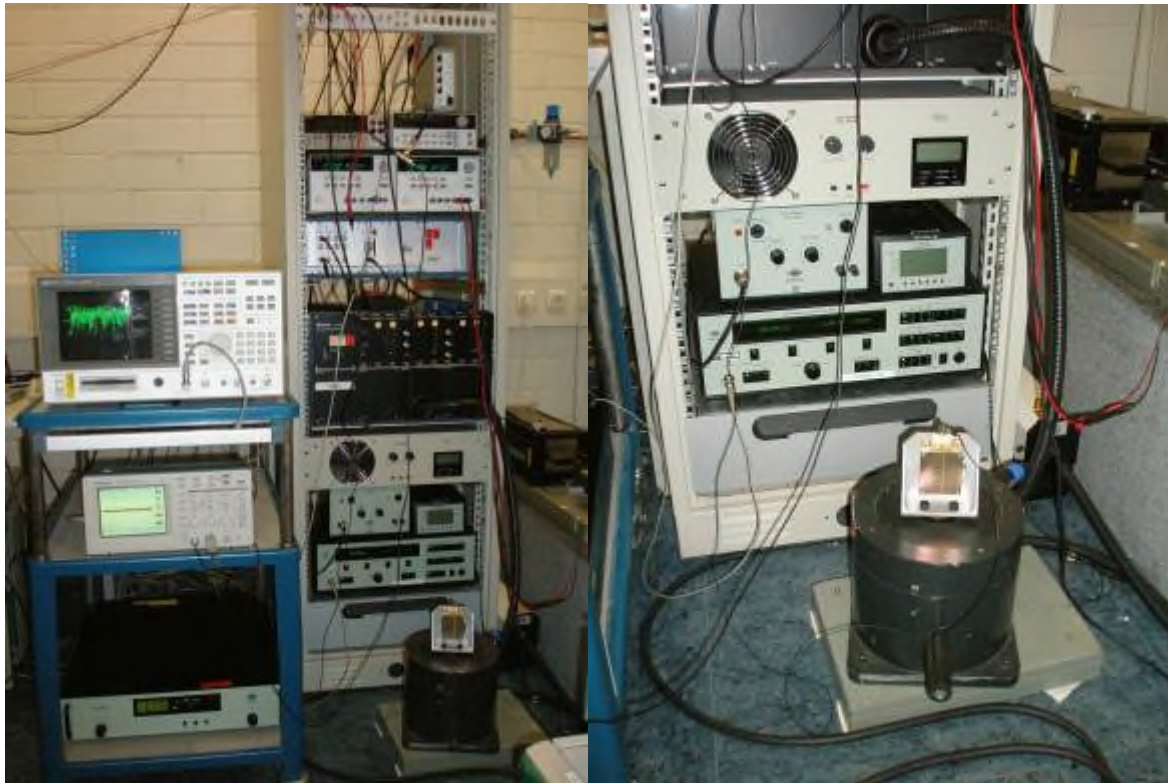
Abbildung 6-19: Shaker-Aufbau für den Sinus-Vibrationstest
