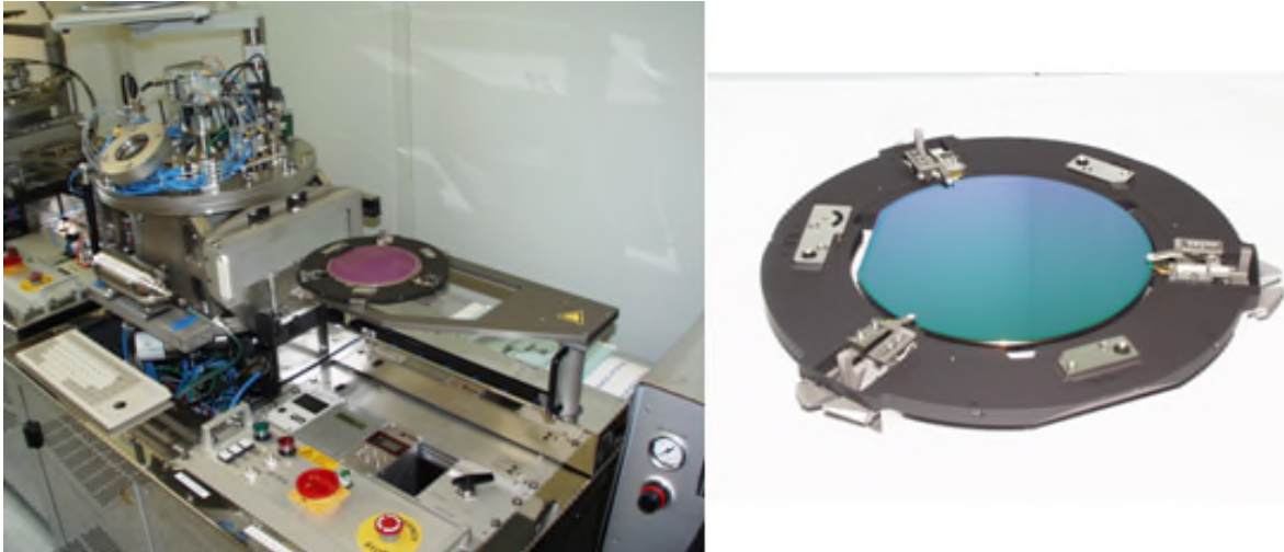
Abbildung 2-5: SUESS SB6 Prober (links) mit vorjustierten Sensor/Kappenwafer (rechts).
