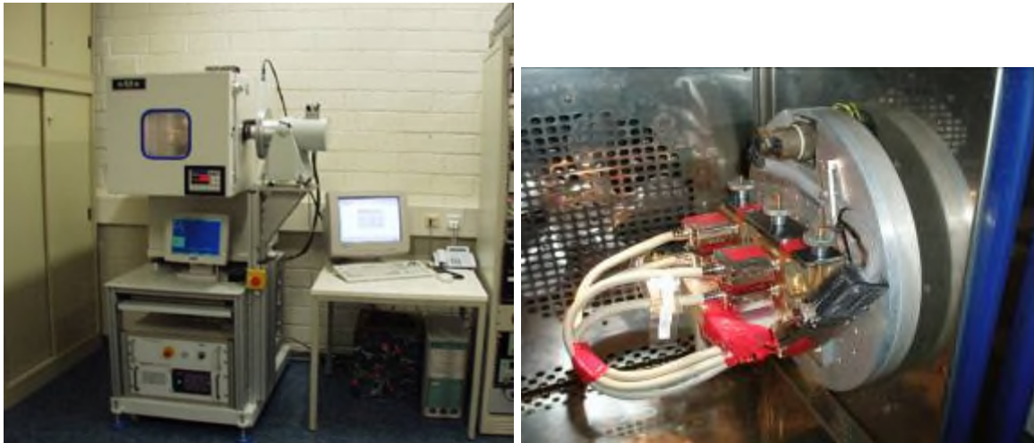
Abbildung 6-4: Bild der Temperaturkammer mit Drehtisch
