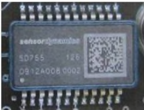
Abbildung 5-1: Sensor für Strahlungstests: Gyro + ASIC
