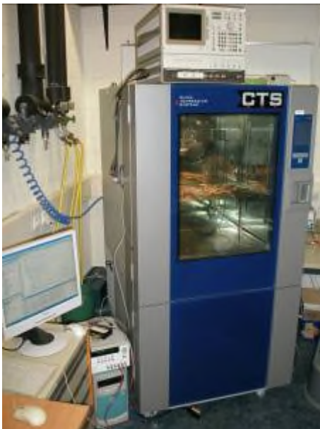
Abbildung 6-12: Messaufbau des Temperatur-Zyklen-Test
