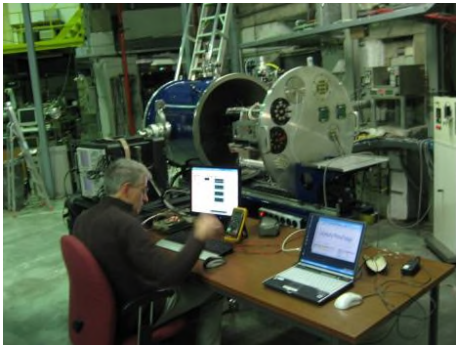
Abbildung 7-24 : Messkammer und Steuerrechner für SEE-Tests
