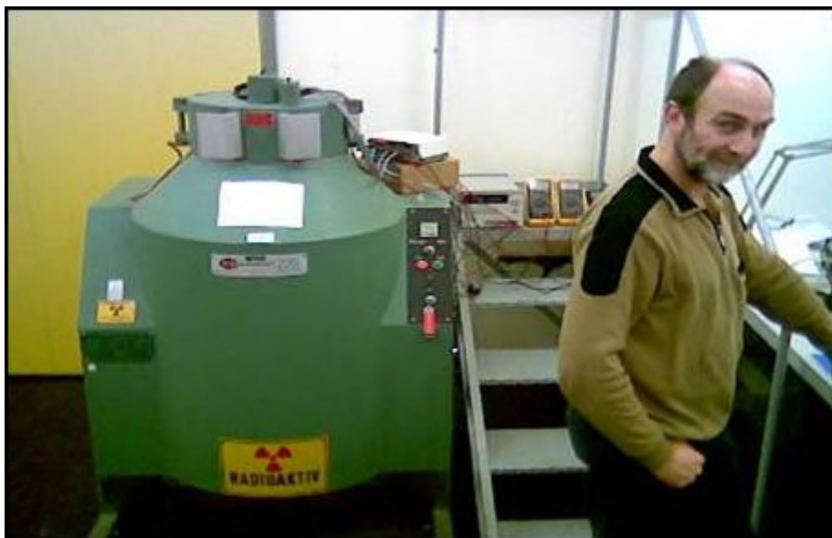
Abbildung 4-5: Co60 Quelle mit Messaufbau für TID-Test
