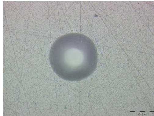
Bild 32: Kalottenschliff, Schichtdicke = 3,7 µm Bild 33: Rockwelltest, HR60 auf THM
