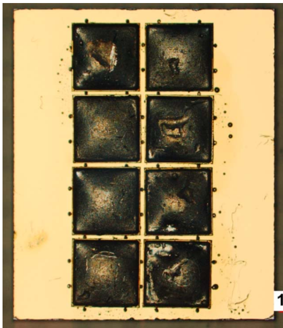
Abb. 73: vergleichende Aufsicht Pad auf AlN Substrat
