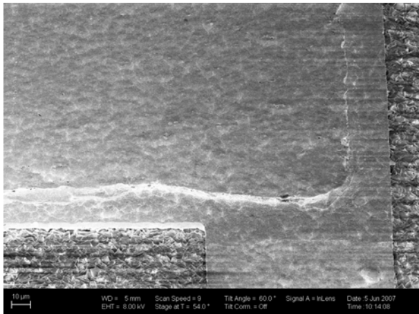
Abb. 44: SEM-Aufnahme der erhabenen Diebondfläche
