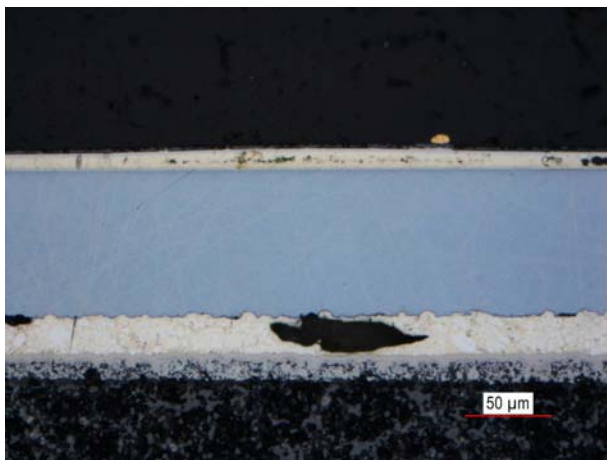
Abb. 22: Querschliff aufgebaute Cree EZBright, Charge Anfang 2006
