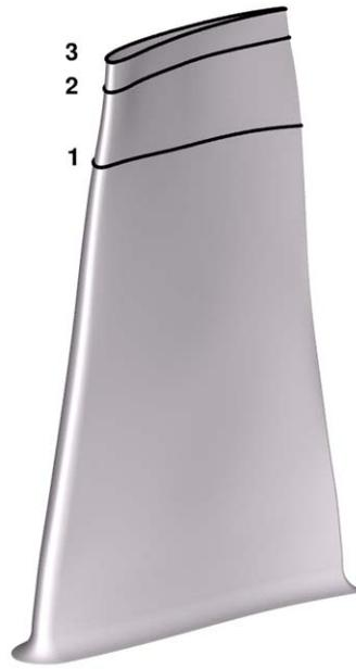
Abbildung 3-36: Lage der Konstruktionsprofile auf der Schaufel
