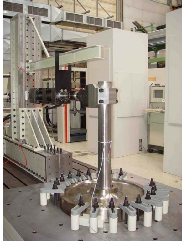
Abbildung 8-11: Prüfstand für 1:1-Proben unter ebener Zweipunktbiegung
