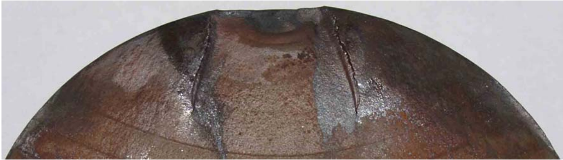
Abbildung 8-17: Bruchfläche (Ausschnitt) einer im Prüfstand angerissenen 1:1-Probe aus EA4T (Flachbiegung)
