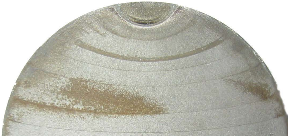
Abbildung 8-4: Durch Lastabsenken erzeugte Rastlinien
