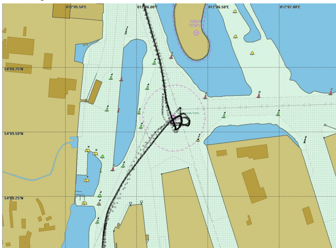
Abb. 8-10 Reale Bahnverläufe vom VDR (= hohe Symboldichte) und AIS
