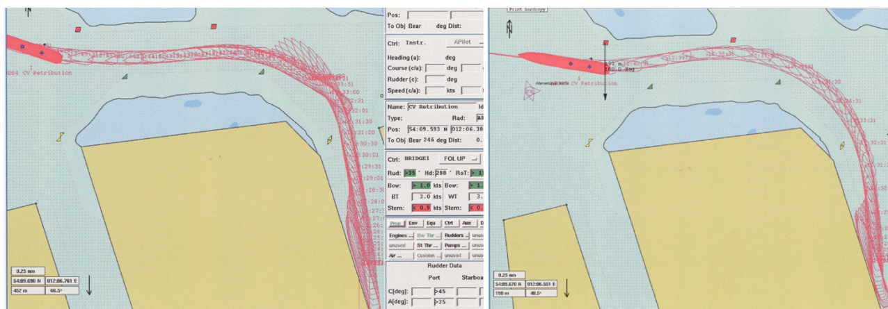
Abb. 8-8 Versuchsergebnisse Beispiele Trackverläufe erfolgreich durchgeführter Fahrten
