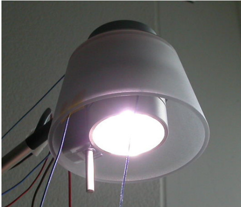
Abbildung 24 Temperaturmessungen am Funktionsmuster
