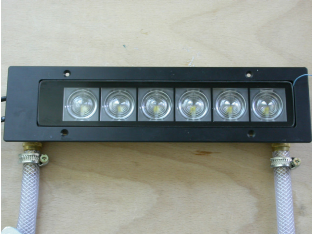
Abbildung 20: LED-Einbauleuchte mit Kühlschlauchanschluss
