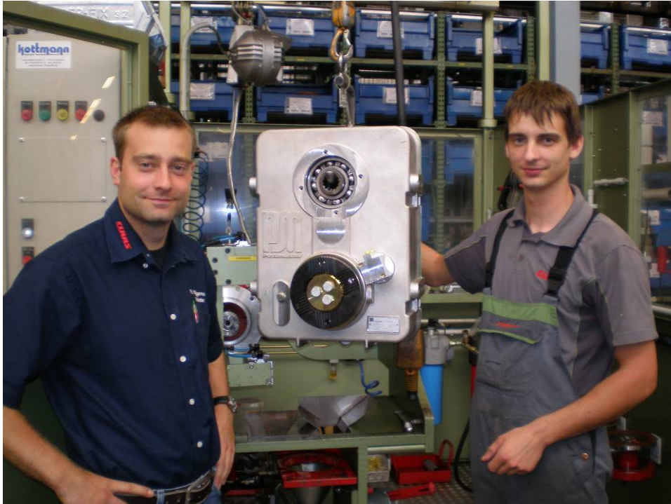
Abbildung 80: Putzmeister-Verteilergetriebe G64C nach erfolgreichem Prüflauf
