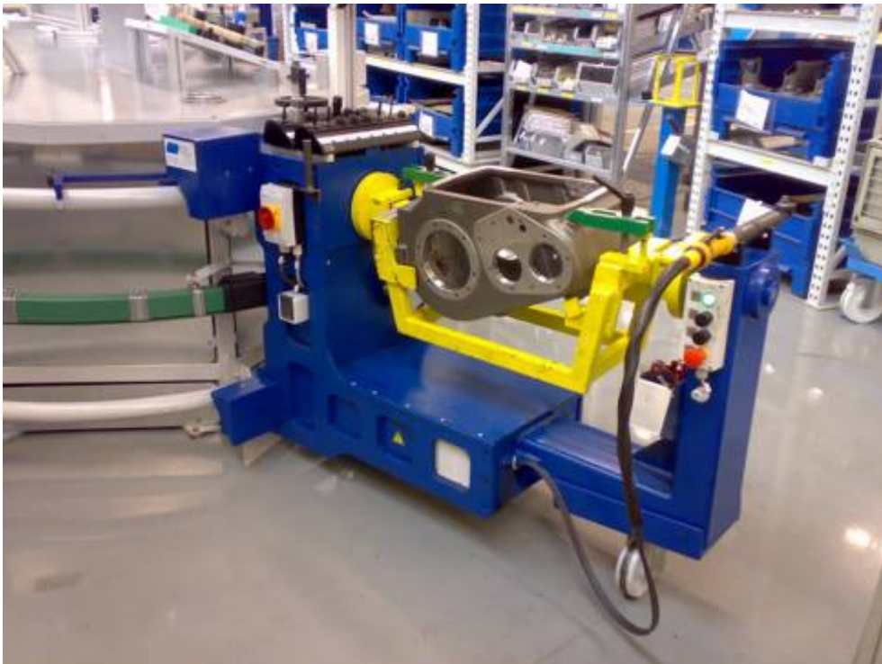
Abbildung 81: Rondell mit Fließmontage Schaltgetriebe
