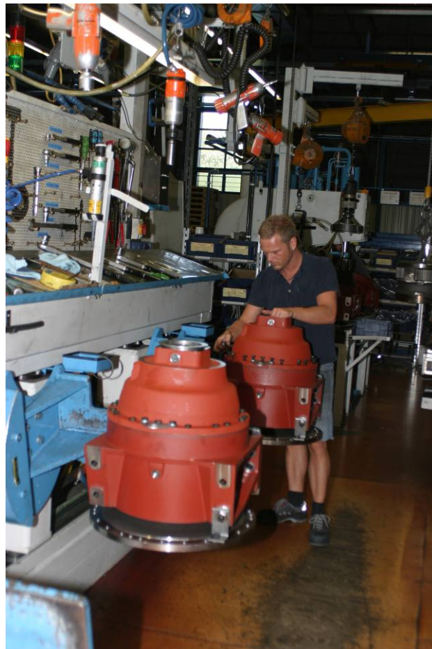
Abbildung 76: Das neue Montagekonzept für die Mischergetriebe
