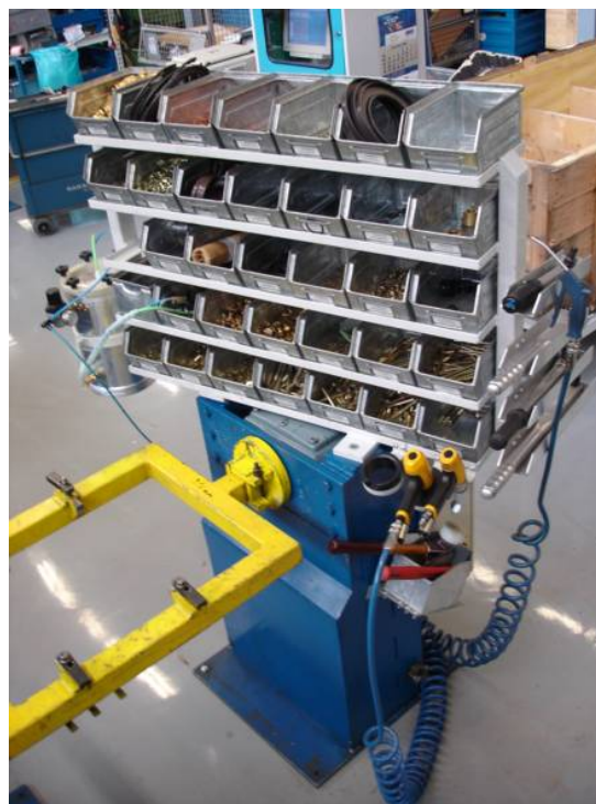
Abbildung 79: Materialbereitstellung am Montageplatz Putzmeister-Verteilergetriebe
