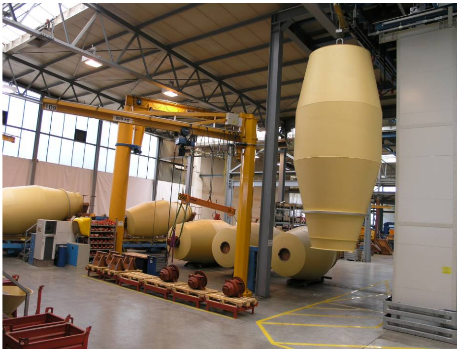
Abbildung 75: Die neue Montagelinie für Fahrmischer
