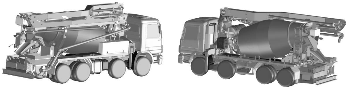
Abbildung 35: Modell eines Demonstrators PUMI ® (Pumpe mit Mischer) der PCP GmbH
