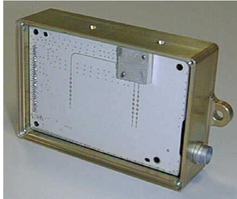
Bild 34: Foto des geöffneten NBR-Sensors, Blick auf die HF-Platine mit den Antennen, der HFSchaltungsteil, befindet sich unter der Aluminium-Abschirmung (Quelle: Continental).
