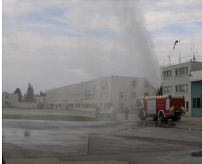
Bild 11: Messkampagne zur Ermittlung der Ausbreitungsdämpfung durch Regen bei 77 GHz, die Spritze des Feuerwehrfahrzeugs versprüht das Wasser mit regulierbarer Tropfengröße.
