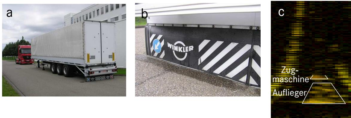
Bild 11: Detektion von verdeckten Objekten a) Szene mit Zugmaschine vor Sattelaufleger, b) Spritzschürze des Auflegers, c) Radarbild in den Koordinaten Entfernung über Azimut.
