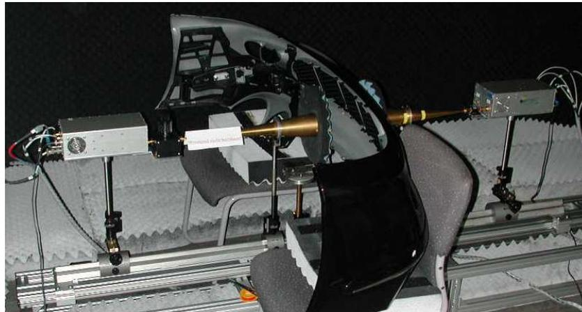
Bild 14: Messaufbau zur Ermittlung der Transmissionseigenschaften eines Kunststoff-Stoßfängers (bistatische Anordnung der Sende- und der Empfangsmodule).
