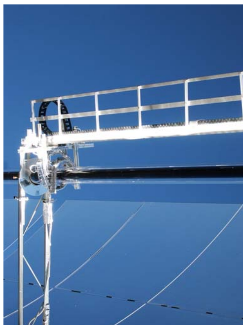
Bild 17: Parascan-2-Messsystem an 76mm-Schott-Receivern auf der PSA, Nov. 2005
