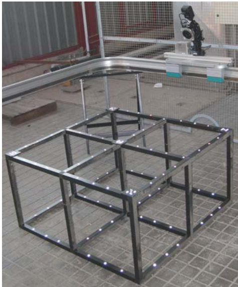
Bild 4: Prototypen-Aufbau auf der PSA mit Schienensystem und Kalibrationsrahmen (links) und Führungswagen mit 3-achsig schwenkbarer Kamera (rechts)
