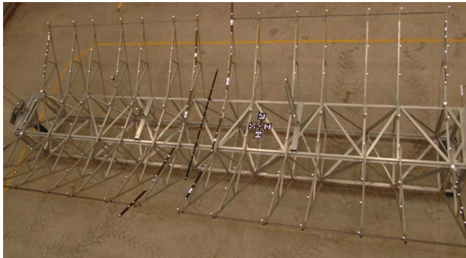
Bild 5: Kollektorstruktur mit Zielmarken bei der 3d-Messung (links). Kamera-Shuttle auf dem Schienensystem (rechts)
