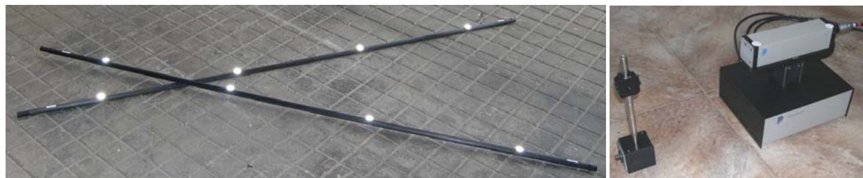
Bild 8: Zwei der CFK-Stäbe mit jeweils vier retro-reflektierenden Zielmarken (links); Laser-Doppler-Distanzmesser zur hochgenauen Vermessung der Targetabstände auf den bis zu 14 m langen CFK-Stangen (rechts)
